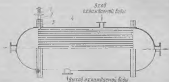
Рис. 2. Схема приварки волноводной колебательной системы на теплообменный аппарат агрегата ТВ-3000:
