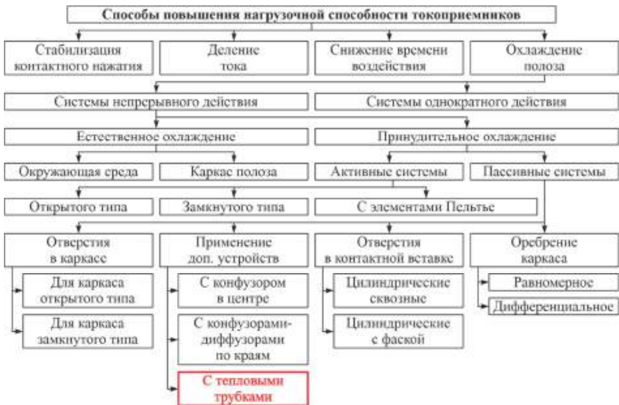
Рисунок 2 – Способы повышения нагрузочной способности токоприемников
