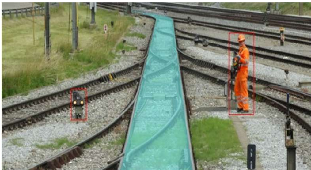
Рисунок 3 – Определение запланированного маршрута и обнаружение препятствий (объектов) на пути следования подвижного состава
