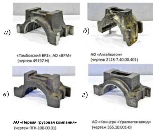
Рисунок 5 – Конструктивное исполнение адаптеров разными производителями
