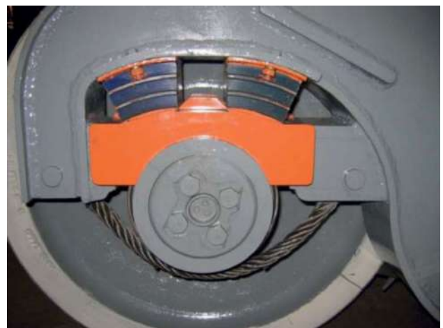
Рисунок 7 – Первая ступень подвешивания тележки модели 18-9750 в виде полиуретано-металлических амортизаторов
