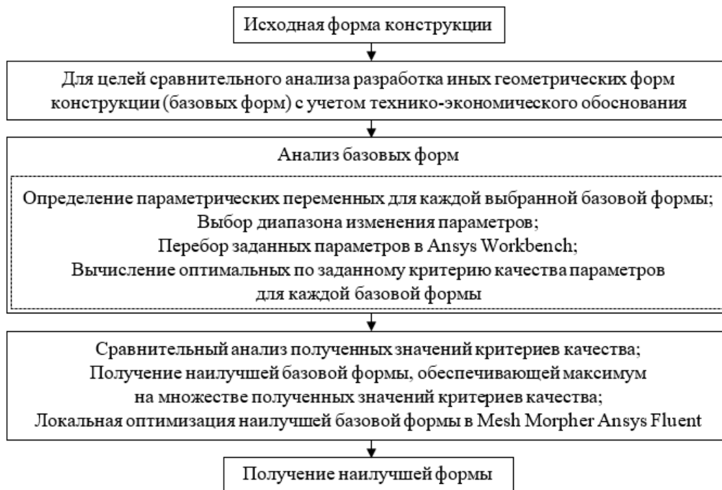
Рисунок 4 – Методика CFD-оптимизации в программном комплексе Ansys
