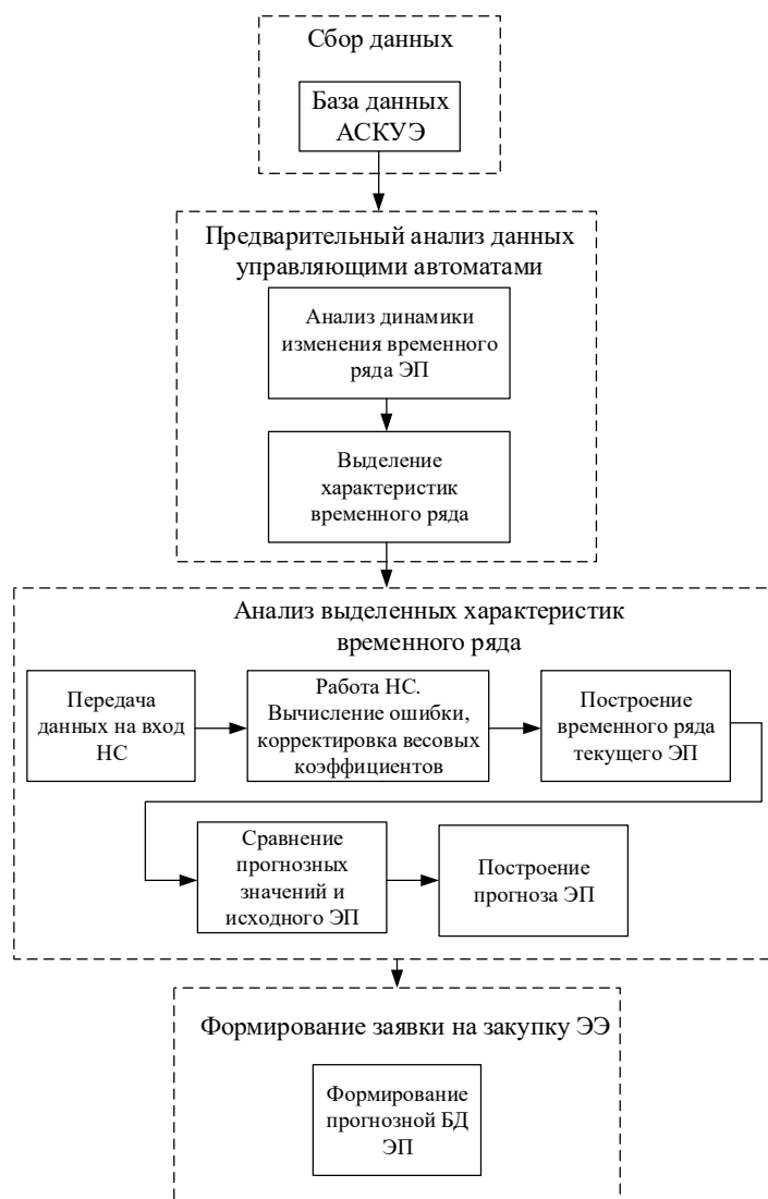
Рисунок 7 – Структурная схема предлагаемой модели прогнозирования
