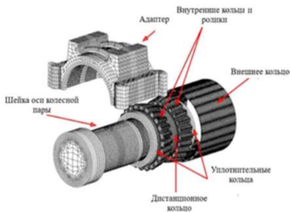
Рисунок 4 – Конструктивное исполнение адаптерного буксового узла
