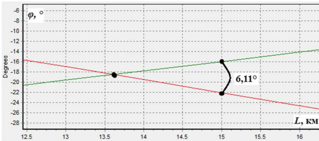
Рисунок 8 – Точка пересечения графиков изменения углов напряжения в контактном проводе К1 при КЗ в т. 1 (1215)
