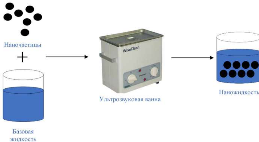
Рисунок 5 – Двухстадийный метод подготовки наножидкости
