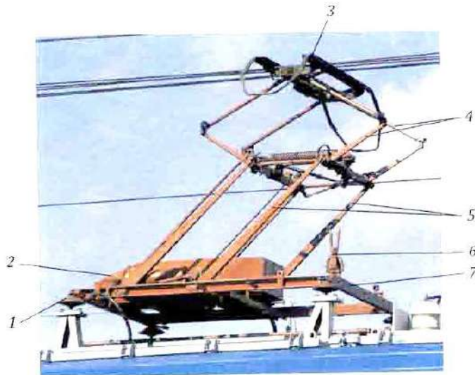
Рисунок 6 – Токоприемник ТСП-1м: 1 – изолятор; 2 – кожух механизма подъема; 3 – полз; 4 – подвижные рамы верхней системы; 5 – подвижные рамы нижней системы; 6 – блокировка; 7 – основание
