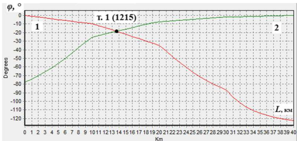
Рисунок 6 – Графики углов напряжений в контактном проводе первого пути (К1), полученные в ПВК «ОМП» для т. 1 (1215)
