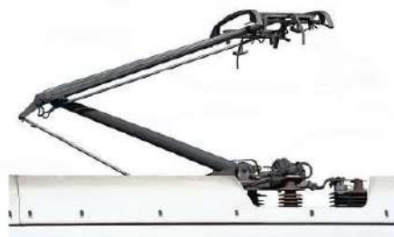
Рисунок 4 – Токоприемник DSA350SEK , разработанный в Германии
