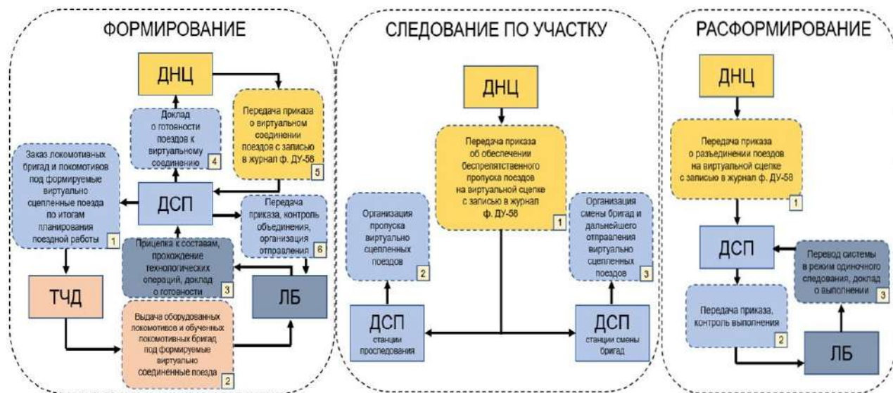
Рисунок 3 – Схема взаимодействия работников при организации движения виртуально соединенных поездов при действующей технологии (здесь и далее ДНЦ – поездной диспетчер, ДСП – дежурный по станции, ТЧД – локомотивный диспетчер, ЛБ – локомотивные бригады виртуально соединенных поездов)
