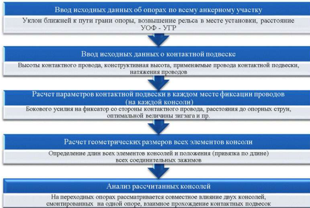
Рисунок 4 – Порядок расчета геометрии консоли
