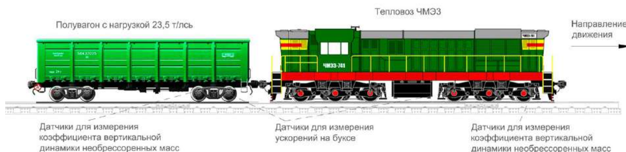
Рисунок 9 – Схема расстановки датчиков измерения на опытном подвижном составе
