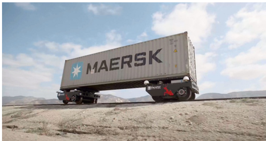
Рис. 1 – Моторные тележки Parallel для перемещения контейнеров [3]
