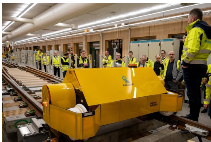
Рис. 4 – Робот Railchar предназначен для автономной диагностики и мониторинга критически важных элементов железнодорожной инфраструктуры, в первую очередь – стрелочных переводов
