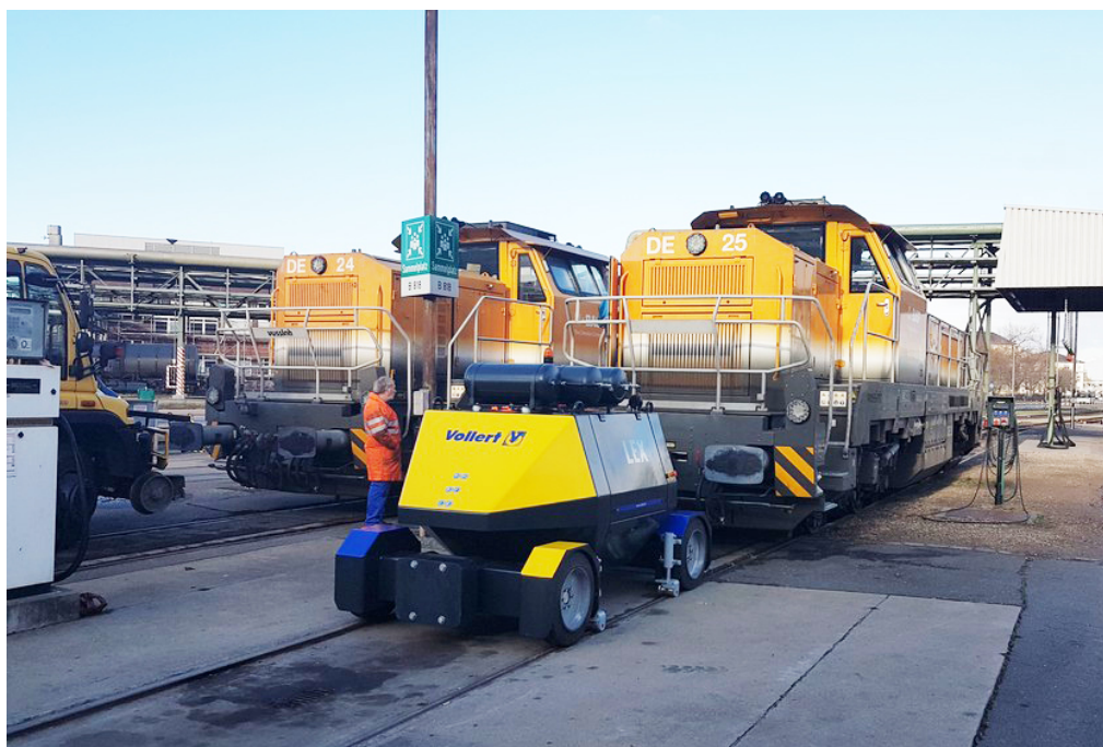
Рис. 2 – Маневровые работы с помощью робота VLEX [8]
