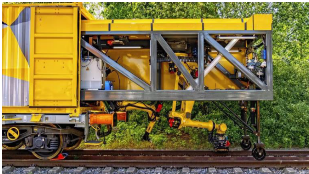
Рис. 5 – Роботизированная система FANUC (предназначена для автоматизации полного цикла ремонтных работ на железнодорожных путях, включая высокоточные операции по восстановлению рельсов)
