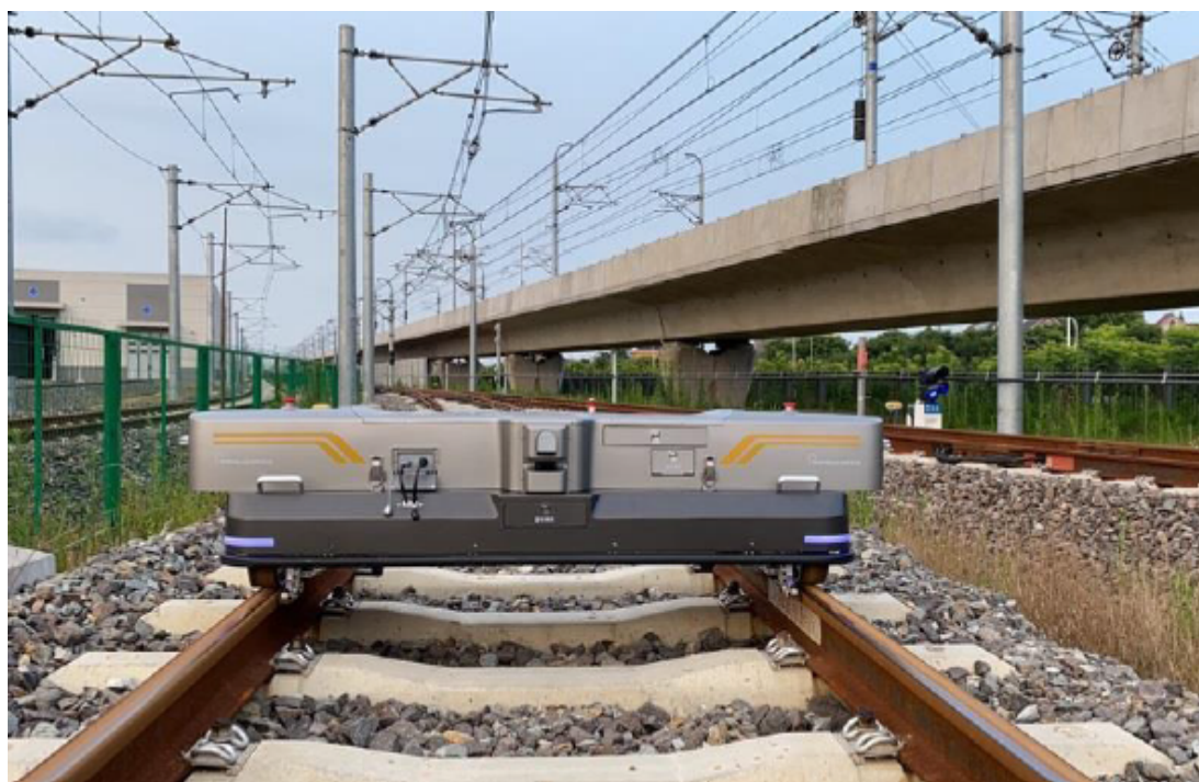
Рис. 1 – Робот для инспекции железных дорог RIIS1005 выполняет комплексный высокоточный мониторинг состояния железнодорожной инфраструктуры, в первую очередь рельсового полотна
