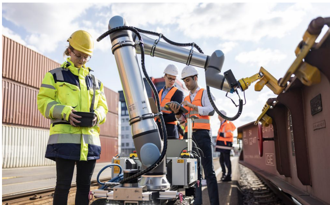
Рис. 3 – Робот проекта Pin Handling mR выполняет автоматизацию трудоёмких и опасных операций с крепёжными элементами на сортировочных станциях и грузовых терминалах
