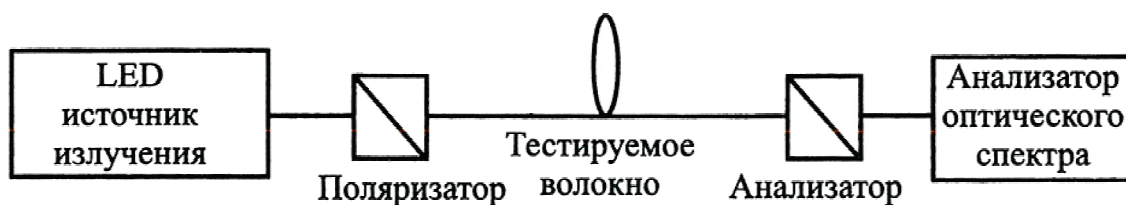
Схема измерения PMD анализатором оптического спектра
