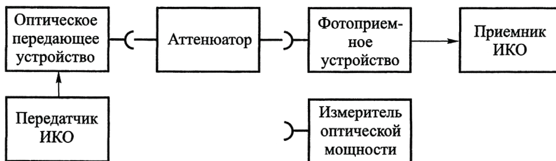
Рис. 4.7. Схема измерения чувствительности ФПУ
