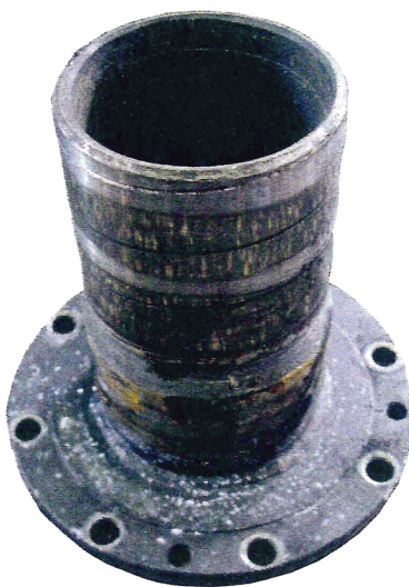
Рис. 11. Стальной стакан токосъемного устройства
