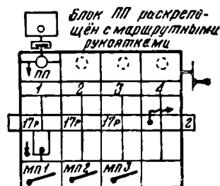
Фиг. 101. Механическая связь блока ПП с маршрутными рукоятками
