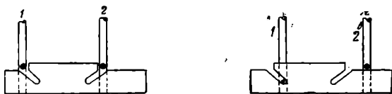
Фиг. 45. Слева блок-механизмы отблокированы. Можно нажать 1 или 2 клавишу. Справа клавиша 1 нажата; блок-механизм заблокирован, линейка заперта в крайнем левом положении, клавишу 2 нажать нельзя
