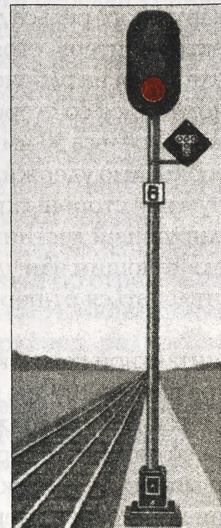
Рисунок 16. Условно-разрешающий сигнал светофора, подаваемый щитом с отражательным знаком прозрачно-белого цвета в виде буквы «Т»: разрешает грузовому поезду проследовать светофор с красным огнем.
