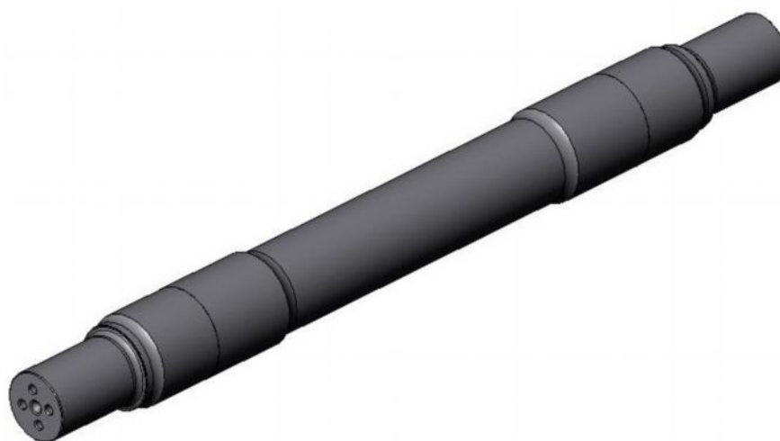
Рисунок 6 - Ось колесной пары
