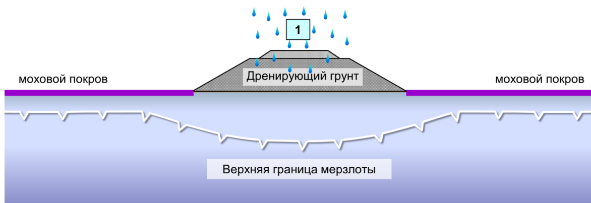
Рис. 3. Схема отепляющего воздействия атмосферных осадков для насыпи из дренирующего грунта: 1 – летние осадки
