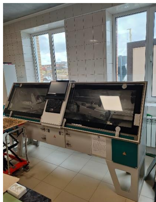
Рис. 2. Вид установки для испытания прокатыванием нагруженного колеса
