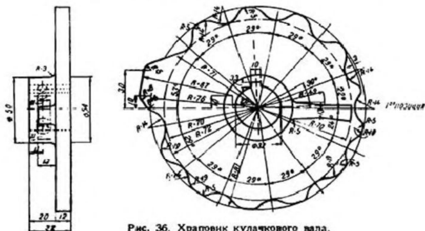
Рис. 36. Храповик кулачкового вала.
