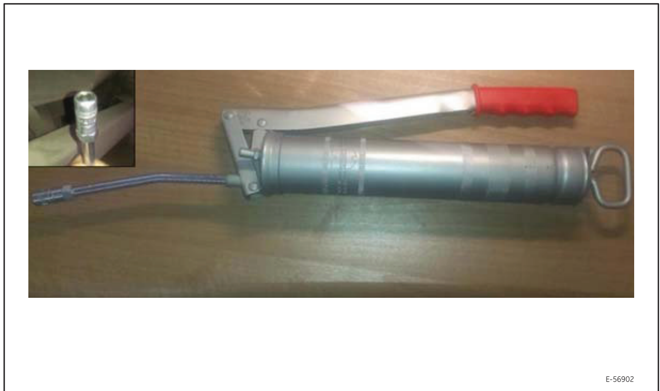
Рисунок 4. Смазочный пистолет с наконечником и рычажным приводом.
