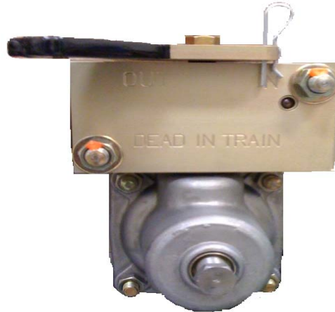
Рис. 6 Транспортировка в холодном состоянии в составе поезда
