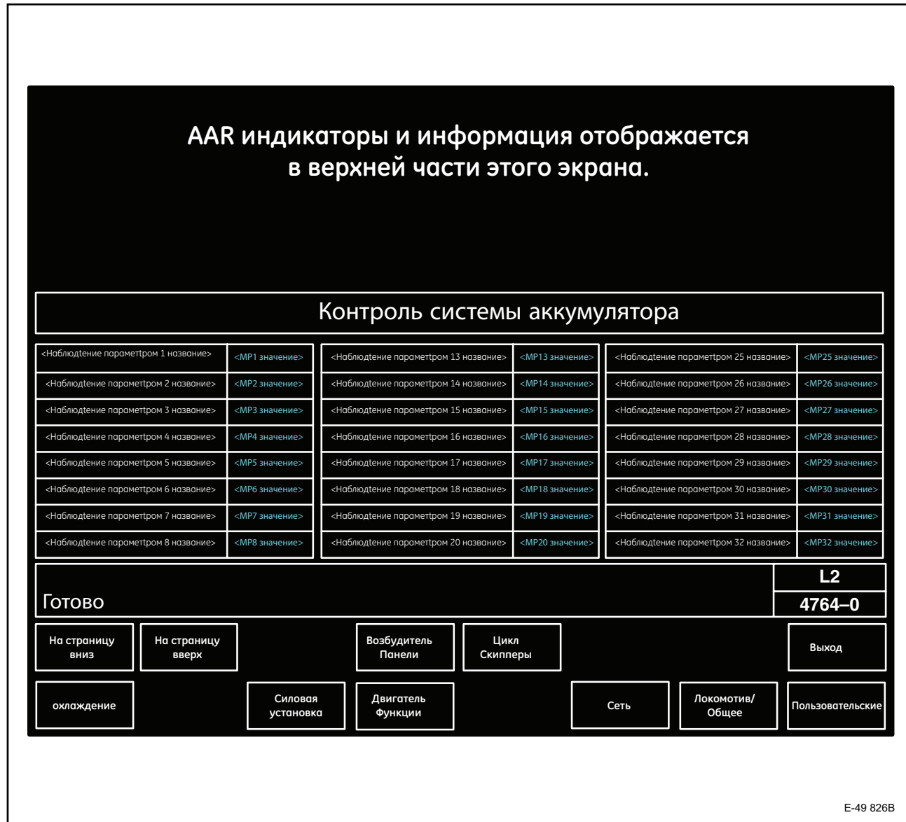
Рисунок 40. Типовой экран контроля системы аккумуляторов (4764-0)
