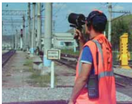
Сканирование элементов контактной сети детектором «Ингулла» и определение конкретного источника радиопомех
