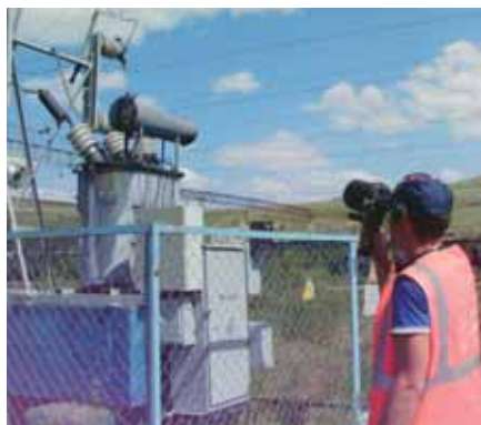
Прослушивание шума от СК-6 и изоляторов ультразвуковым детектором «Ингулла»
