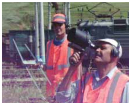
После определения приёмником-радиопеленгатором «Алтай-145» местоположения мощного источника радиопомех сканируются элементы контактной сети
