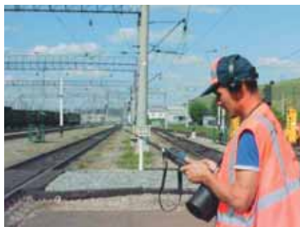
В процессе продвижения вдоль пути определяется по максимальному показанию анализатора АКС-1201 местоположение источника радиопомех первой величины
