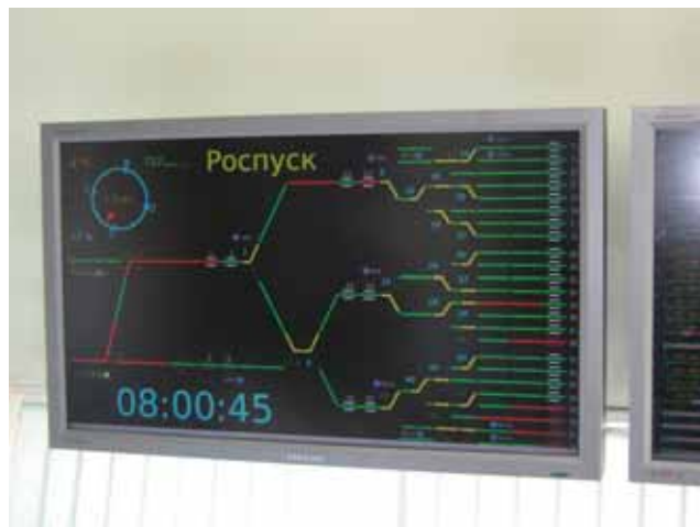
Монитор в составе АРМ дежурного по горке системы КСАУ СП
