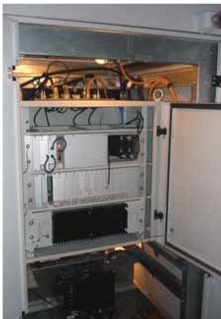
Системный шкаф комплекса БЛОК (испытание опытного образца)
