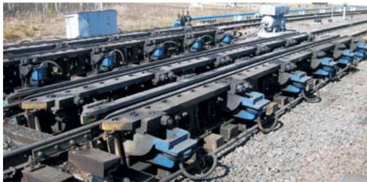
Универсальный вагонный замедлитель КНЗ-5пк
