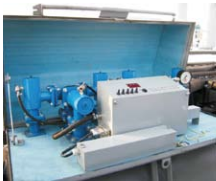
Воздухосборник с управляющей аппаратурой ВУПЗ-05Э
