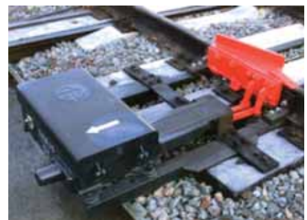
Модернизированный колесосбрасывающий башмак
