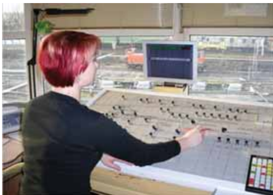
Рабочее место дежурного по горке с АРМом ГАЦ-АРС ГТСС
