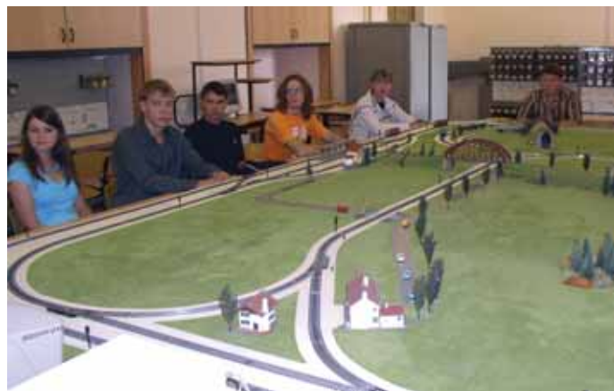
Макет железной дороги, оснащенной релейно-процессорной системой управления стрелками и сигналами
