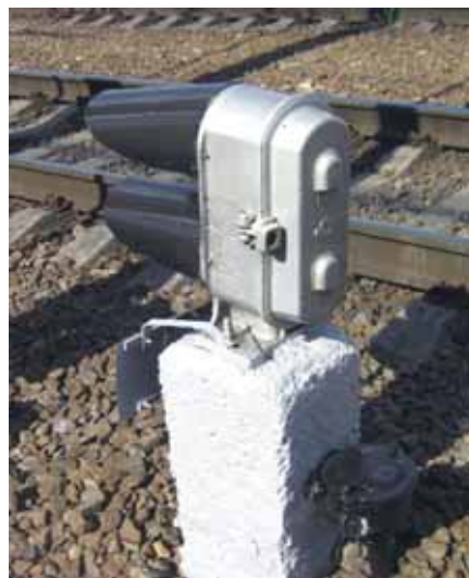
Маневровый сигнал до покраски бригадой ООО «МобилСтрой», сразу после нее и два года спустя
