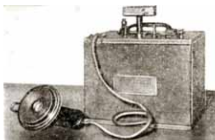
Приемная станция А.С. Попова для приема сигналов на слух, изготовленная парижской фирмой «Дюкретэ»
