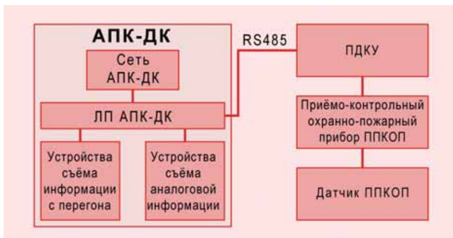
Схема сопряжения системы АПК-ДК с комплексом ОПС и АУГПТ по интерфейсу RS485
