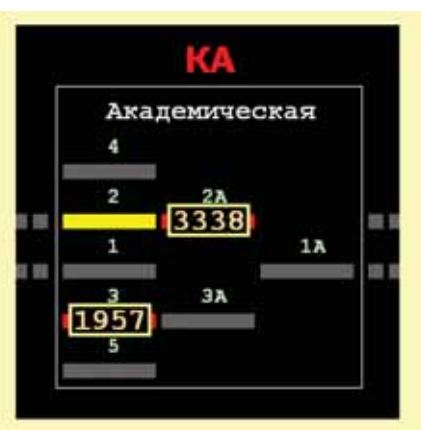
Отказ устройств СЦБ на станции, признак «КА» – контроль аварии
