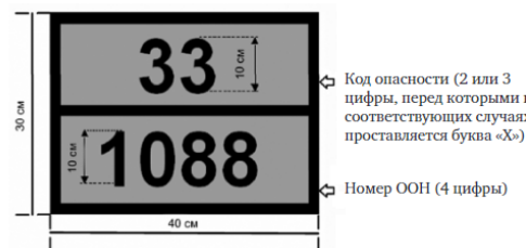
Рис. 2. Пример размещения на оранжевой карточке кода опасности и номера ООН: фон — оранжевый; окантовка, поперечная полоса и цифры — черного цвета с толщиной линий 15 мм; для каждого размера таблички оранжевого цвета предусматривается допуск \pm 10\%
