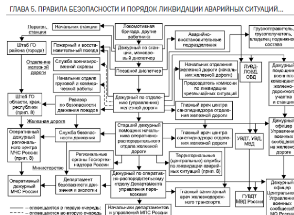
Рис. 6. Схема оповещения при возникновении аварийной ситуации с опасными грузами
