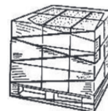
Рис. 1.6. Крепление при помощи растягивающейся пленки
