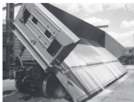
Рис. 8. Саморазгружающийся вагон-самосвал (думпкар)
