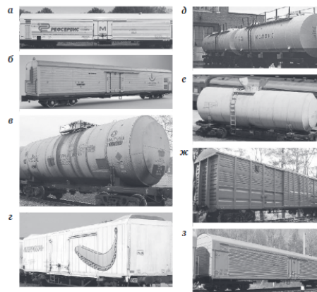
Рис. 37. Вагоны для перевозки скоропортящихся грузов: а — автономный рефрижераторный вагон (АРВ); б — вагон-термос; в — цистерна-термос; г — рефрижераторный вагон для перевозки бананов; д — молочная цистерна-термос; е — вагон-цистерна для перевозки виноматериалов; ж — универсальный крытый вагон; з — изотермический вагон, модель ЦБ-5-659
