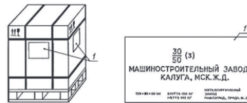
Рис. 3. Пример расположения маркировочных ярлыков на транспортном пакете
