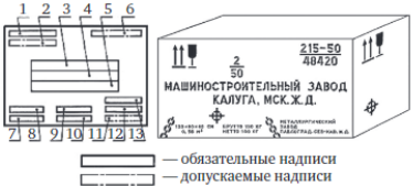
Рис. 1. Расположение транспортной маркировки: 1 — манипуляционные знаки (предупредительные надписи); 2 — допускаемые предупредительные надписи; 3 — количество мест в партии, порядковый номер внутри партии; 4 — наименование грузо-получателя и пункта назначения; 5 — наименование пункта перегрузки; 6 — надписи транспортных организаций; 7 — объем грузового места (для грузов, предназначенных на экспорт); 8 — габаритные размеры грузового места; 9 — масса брутто; 10 — масса нетто; 11 — страна-изготовитель и (или) поставщик; 12 — наименование пункта отправления; 13 — наименование грузоотправителя
