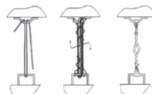
Рис. 19. Установка растяжек по способу 3
