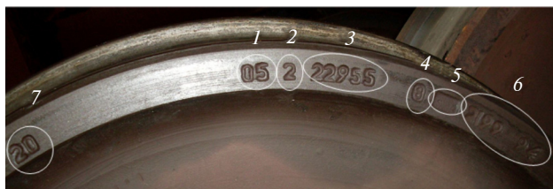
Рис. 2.8. Клейма и знаки маркировки, относящиеся к изготовлению колеса:
