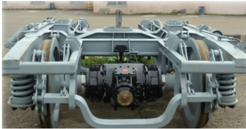
Рис. 13.4. Редукторно-карданный привод от средней части оси
