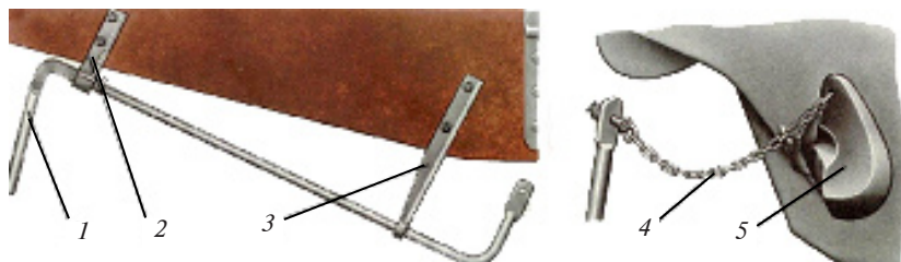
Рис. 3.5. Устройство расцепного привода автосцепки СА-3
