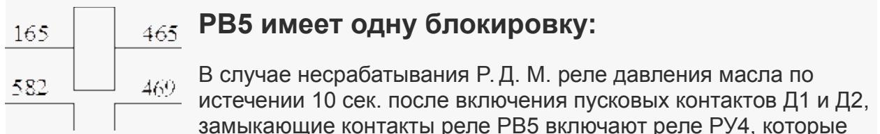
через реле РВ2 с выдержкой времени 5 сек. отключают аппараты схемы запуска дизеля, т. е. РВ5 ограничивают время запуска дизеля до 15 сек.
