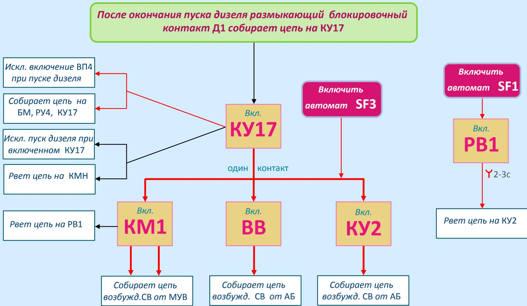
После выхода возбудителя в режим самовозбуждения блок регулирования системы УСТА управляет тиристорами управляемого выпрямителя модуля МУВ таким образом, чтобы напряжение между зажимами 14/1 («плюс») и 4/4 («минус») поддерживалось равным  $75 \pm 1$  В.
