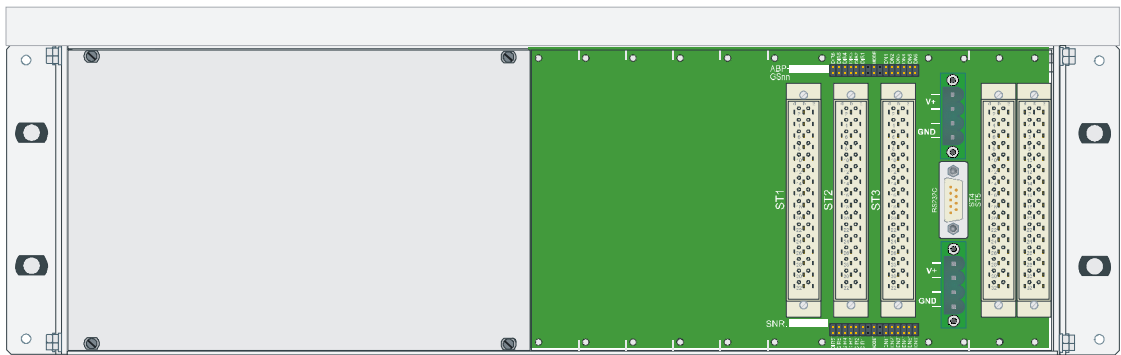
Abb. 7.1-2: Rückansicht des Baugruppenträgers Type BGT04 mit Beschriftungsleiste und einer ABP
