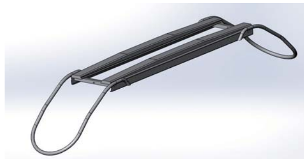
Рис. 4. Внешний вид изолированного полоза токоприемника упрощенной сборки для моделирования
