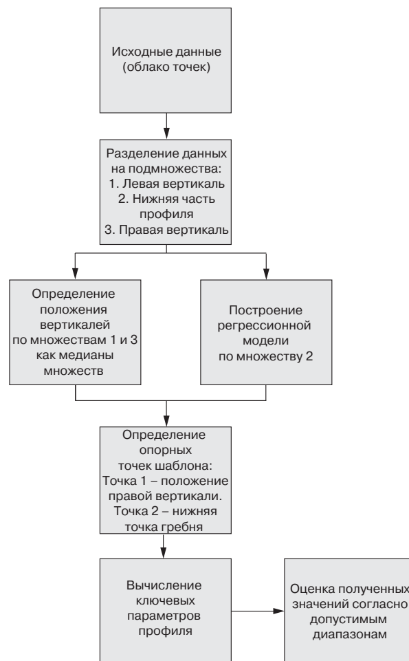
Рис. 4. Структурная схема оценки параметров профиля колеса
