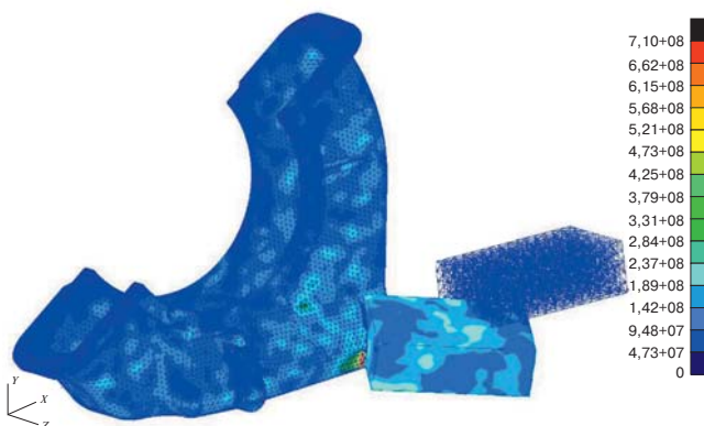
Рис. 20. Начальная фаза разрушения корпуса редуктора при скорости куска льда 79 м/с (максимальная пластическая деформация материала 5%)
