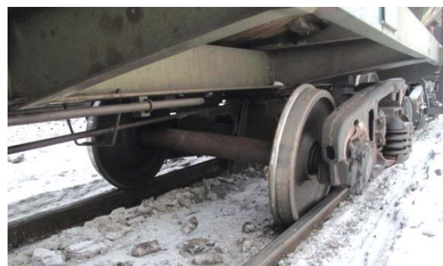
Рис. 2. Случаи проваливания колеса внутрь колеи Фото из открытых источников
