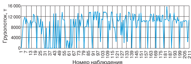
Рис. 6. Колебания величины грузопотока на участке курсирования кольцевых маршрутных поездов после введения резерва вагонов
