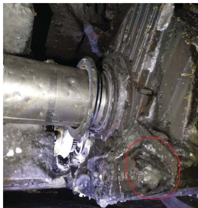
Рис. 2. Разрушение картера корпуса редуктора с образованием отверстия (выделено кружком) и последующим разрушением узлов тяговой передачи
