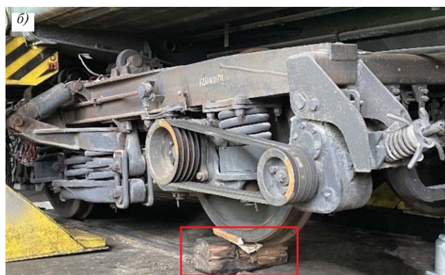
Рис. 10. Имитация схода с провалом первого по ходу движения колеса: а — обезгруживание первого колеса; б — опускание кузова вагона с тележкой на опоры, установленные под три колеса
