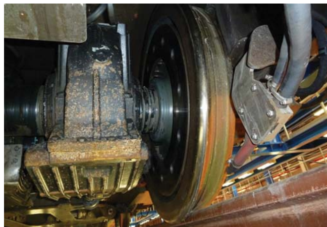
Рис. 1. Разрушения окраски корпуса редуктора из-за ударного воздействия щебня
