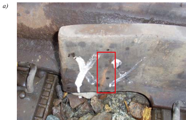
Рис. 12. Трещины литой части цельнолитого блока моноблочной крестовины в районе улавливающего желоба: a — вид слева; б — вид справа
