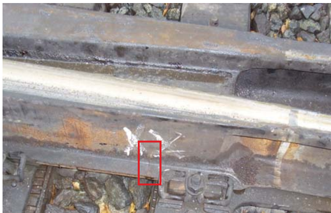
Рис. 13. Трещина в районе переднего вылета цельнолитого блока моноблочной крестовины
