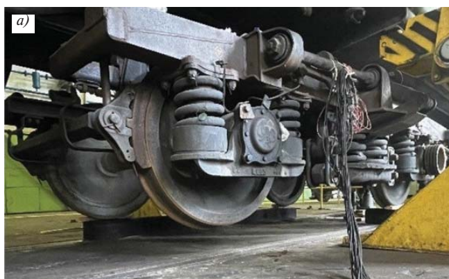
Рис. 10. Имитация схода с провалом первого по ходу движения колеса: а — обезгруживание первого колеса; б — опускание кузова вагона с тележкой на опоры, установленные под три колеса
