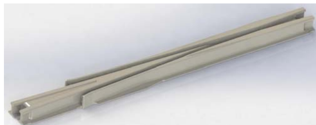
Рис. 1. 3D-модель цельнолитого блока моноблочной крестовины типа Р65 марки 1/11 (внешние поверхности)
