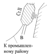
Рис. 10.7. Узел крестообразного типа с местным обходом
