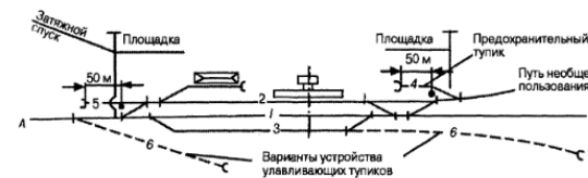
Рис. 2.1. Схема станции с предохранительными (4, 5) и улавливающими (6) тупиками
