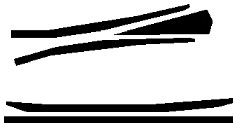
Рисунок 11 – Схема взаимного расположения сердечника крестовины, контррельса и усовика
