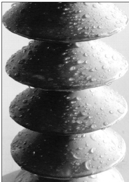
Рис. 1.28. Фрагмент полимерного изолятора из кремнийорганической резины
