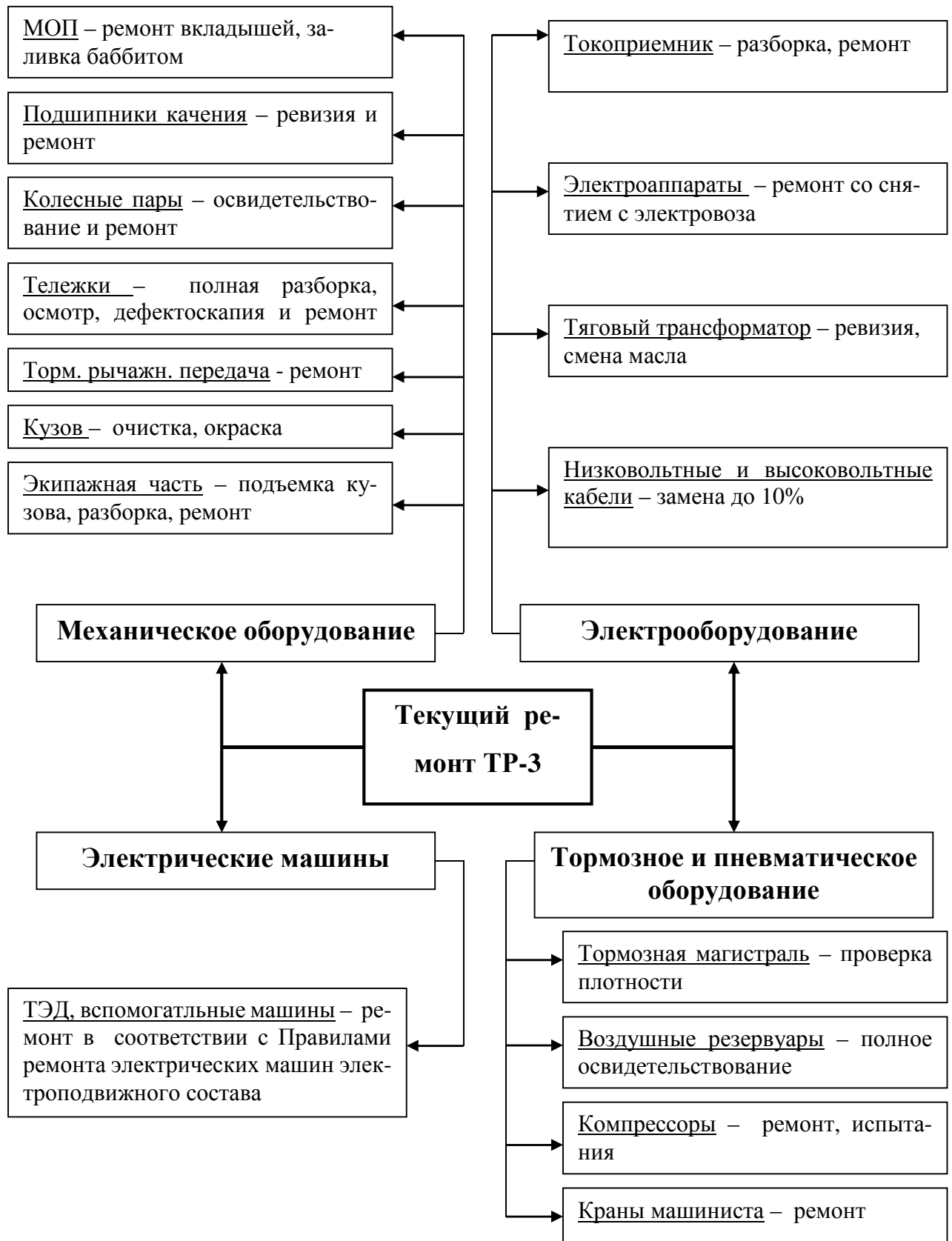
Рис. 4. Схема выполнения текущего ремонта ТР-3 с укрупненными работами по основным узлам электровоза.
