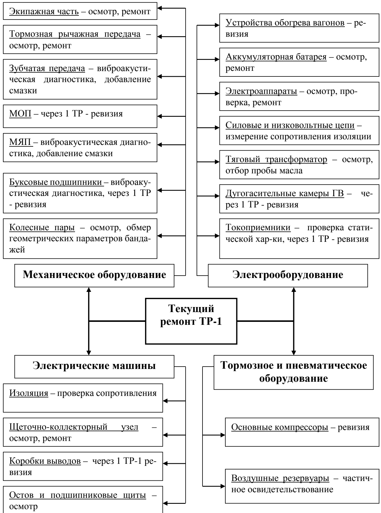
Рис.2 Схема выполнения текущего ремонта ТР-1 с укрупненными работами по основным узлам электровоза
