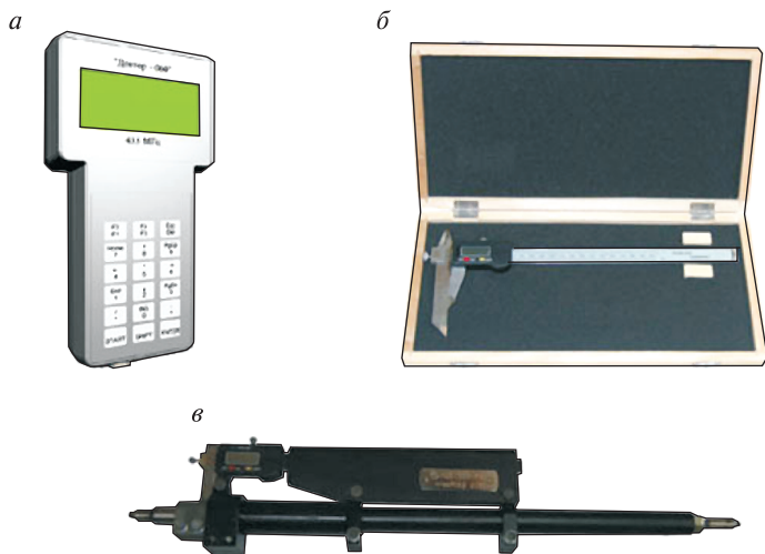
Рис. 48. Мобильный прибор контроля линейных параметров тягового электродвигателя («Доктор-060L»):
