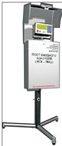
Рис. 47. Рабочий пост комплексной системы контроля качества тяговых электродвигателей
