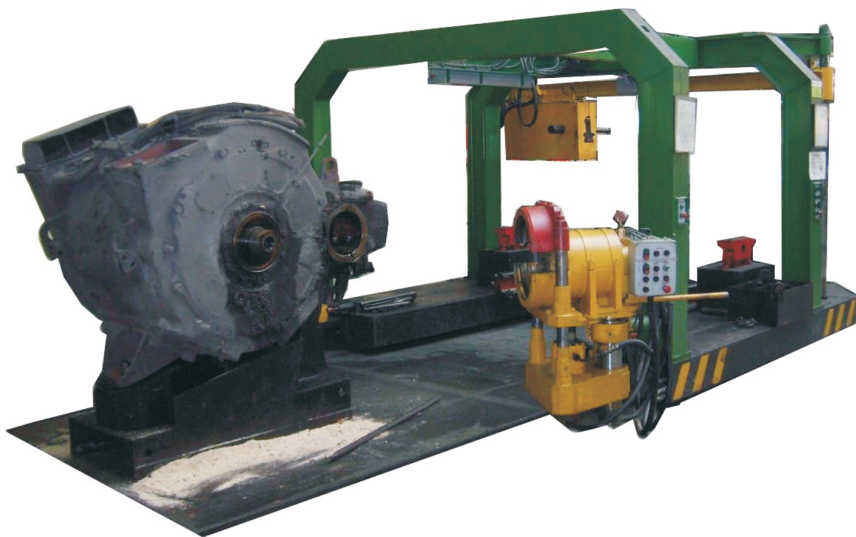
Рис. 21. Портал для разборки колесно-моторного блока тягового двигателя ТЛ-2К1
