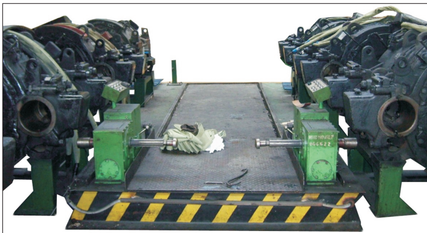
Рис. 40. Механизированная позиция затяжки болтов букс моторно-осевых подшипников (МОП) тягового электродвигателя
