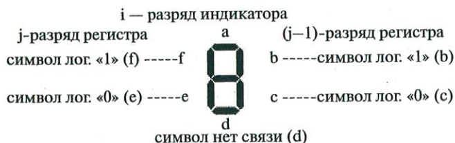
Рис. 4.53. Индикация логических значений при чтении содержимого регистра контроллера
