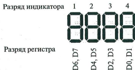
Рис. 4.54. Соответствие разрядов цифрового индикатора контроллера СМК и разрядов регистра
