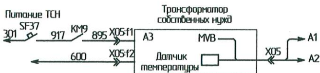
Рис. 5.31. Цепи питания и управления трансформатором собственных нужд
