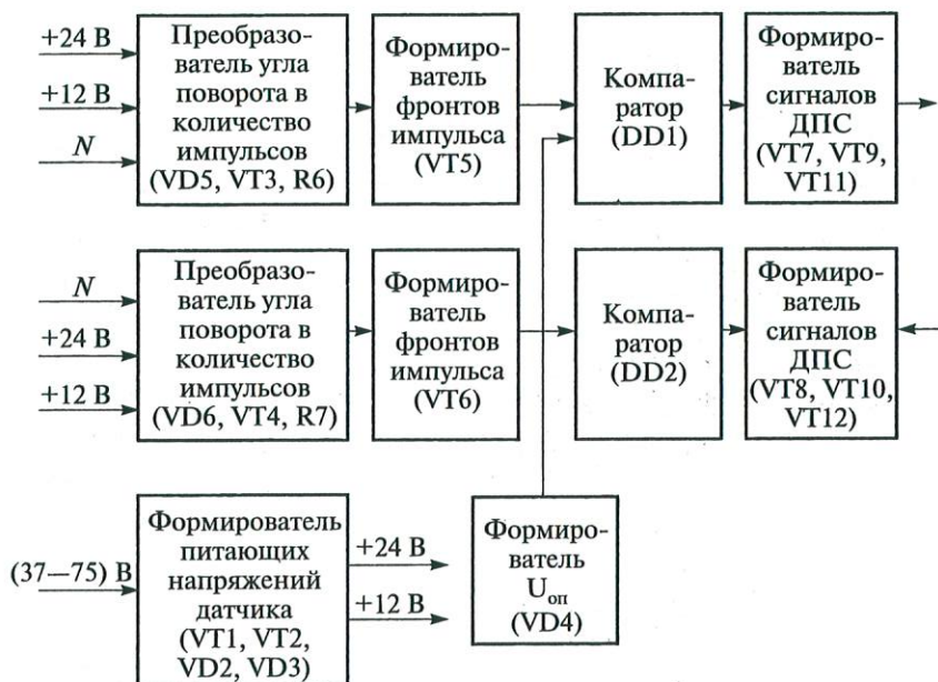
Рис. 4.76. Функциональная схема датчика ДПС-У
