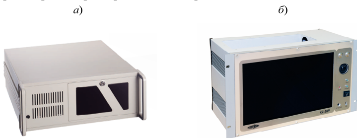
Рис. 2.15. Внешний вид концентраторов информации: а) Advantech 610; б) KR-489
