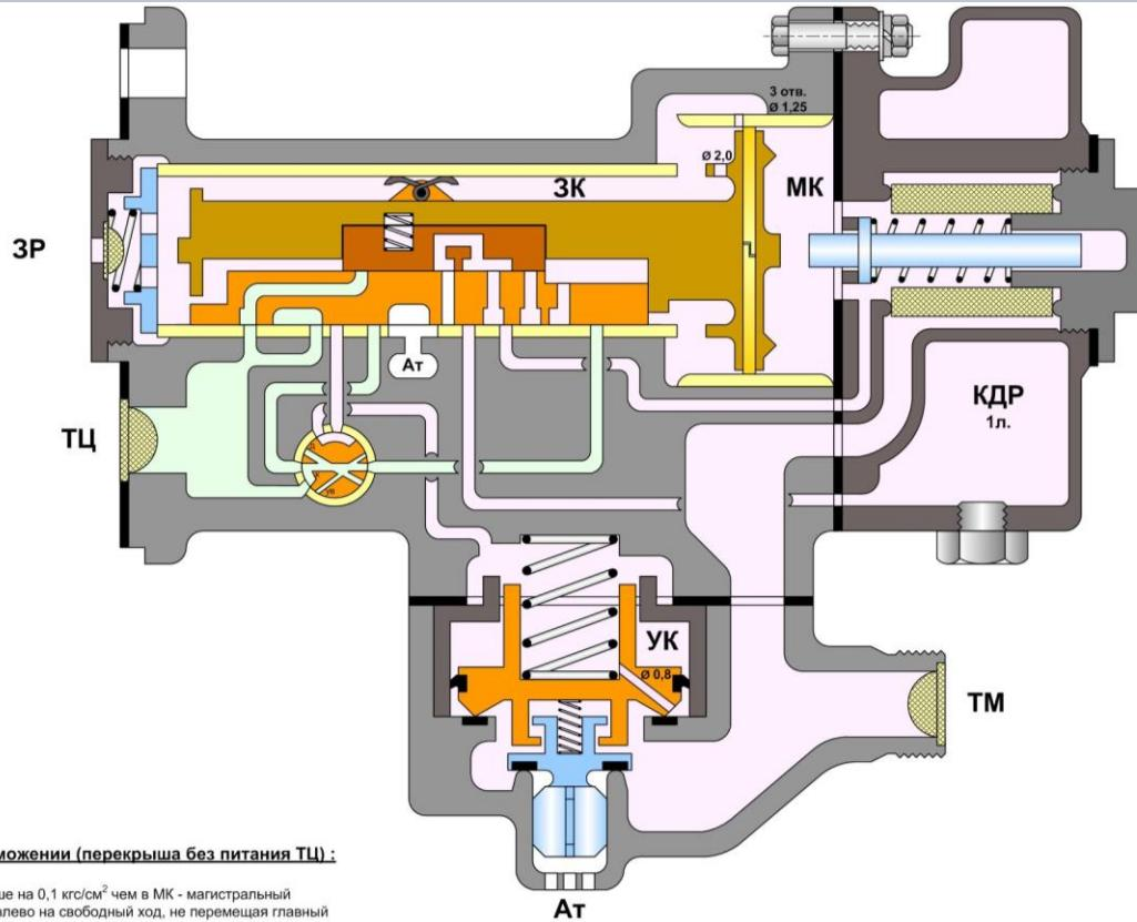
Следование на торможении (перекрыша без питания ТЦ):
