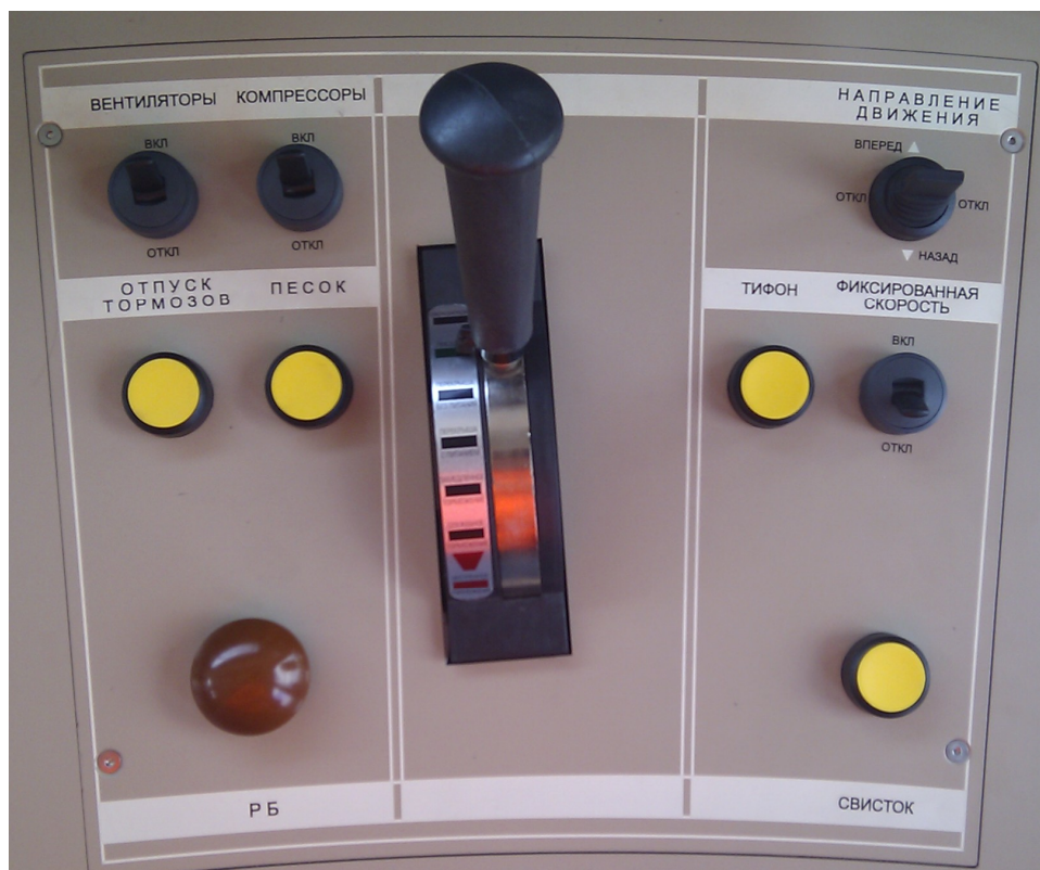
Рисунок 1.48 – Тумблера и кнопки на пульте управления машиниста: тумблер SB27 «Вентиляторы», тумблер SB27 «Компрессоры», переключатель SA41 «Направление движения» (реверсор), тумблер SA41 «Фиксированная скорость», кнопка SB37 «Отпуск тормоза», кнопка SB8 «Песок», кнопка SB3 «Тифон», кнопка SB4 «Свисток»
