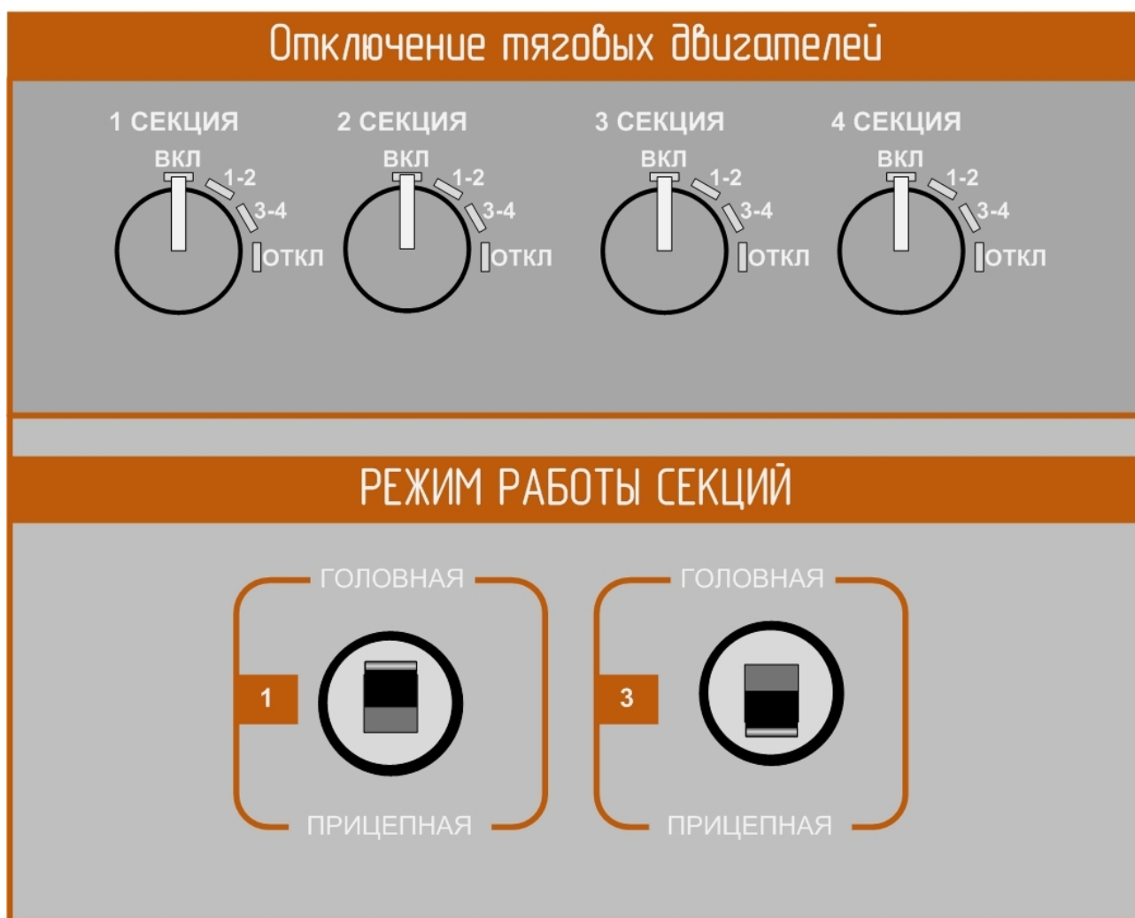
Рисунок 2.1 – Переключатели выключения ТЭД или секций SA28, SA29, SA30, SA31. Переключатели выбора режима работы секций SA32 и SA34
