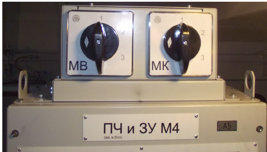
Рисунок 1.42 – Аварийные переключатели «МВ» и «МК» резервирования выходных каналов вентиляторов охлаждения ТЭД и тормозного компрессора
