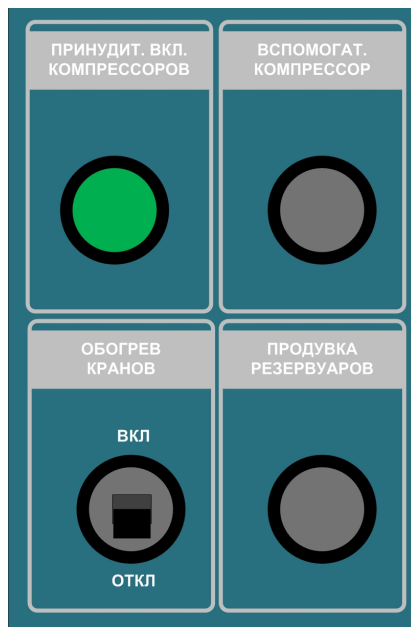
Рисунок 1.51 – Панель управления компрессорами и обогрева клапанов ГР
