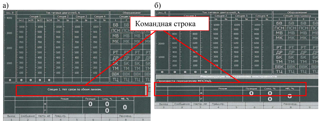
Рисунок 13 – Диагностические сообщения на мониторе МПСУиД в режиме «Машинист» при возникновении неисправности
