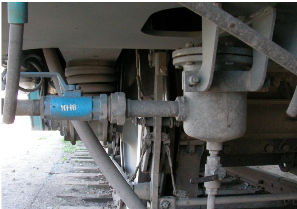
Рисунок 30 – Масловлагоотделитель и кран КН8
