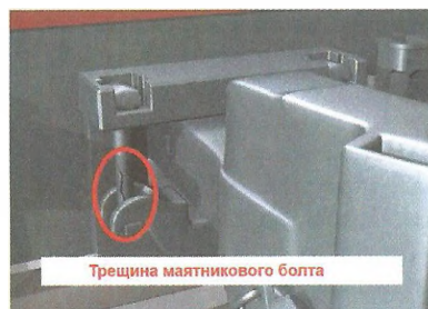
Рисунок 24. Излом или трещина центрирующей балочки, маятниковой подвески (или направляющей рейки центрирующего прибора безмаятникового типа), неправильно поставленные маятниковые подвески (широкими головками вниз)
