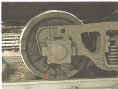
Рисунок 18. Наличие «свежего» выброса смазки на диск, обод, ступицу колеса, детали тормозной рычажной передачи, свежие потеки смазки в нижней части корпуса буксы, наличие запаха разогретой смазки
