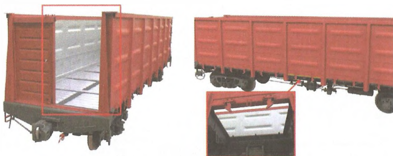
Рисунок 27. Отсутствие крышки люка или створки двери у полувагона
