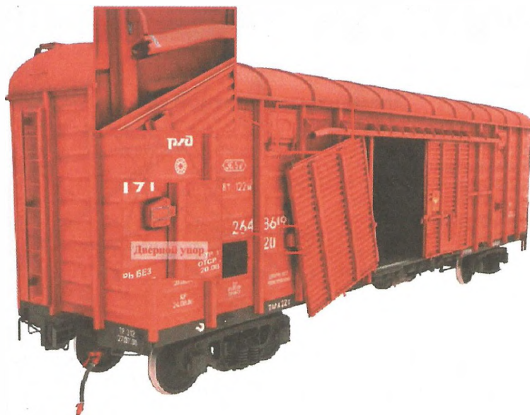
Рисунок 26. Отсутствие двери или дверного упора. Повреждения крепления или изгиб дверных рельсов или повреждение направляющих, угрожающие падением двери на путь
