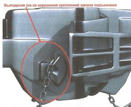
Рисунок 23. Отсутствие валика подъемника автосцепки, не закрепленный от выпадания или закрепленный нетиповым способом валик подъемника
