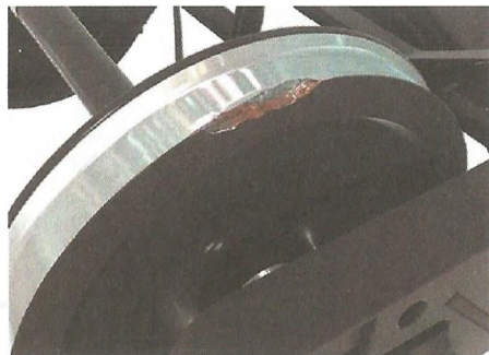
Рисунок 17. Поверхностный откол на- ружной грани обода колеса, включая местный откол кругового наплыва, глу- биной (по радиусу колеса) более 10 мм, или ширина оставшейся части обода в месте откола менее 120 мм, или нали- чие в поврежденном месте независимо от размеров откола трещины, распро- страняющейся вглубь металла
