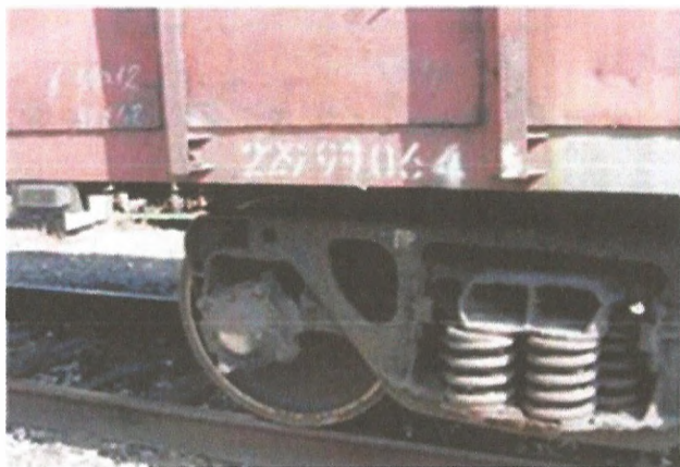
Рисунок 19. Перекос буксы, разворот ее в буксовом проеме боковины тележек
