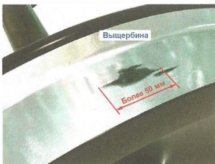
Рисунок 16. Выщербины по поверхности катания колеса глубиной более 10 мм или длиной более 50 мм у грузовых вагонов и более 25 мм у пассажирских вагонов
