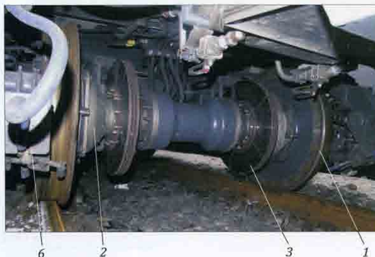
Рис. 13.87. Высокоскоростной электропоезд серии 120/121 «Серия» компании CAF/Alstom: а — общий вид; б — вид тележки со стороны движущей колесной пары; в — вид тележки со стороны поддерживающей колесной пары: 1 — разрезная колесная пара; 2 — кожух, прикрывающий подвижную часть оси колесной пары; 3 — тормозной диск; 4 — осевой редуктор; 5 — фланец входного вала; 6 — механизм перевода и блокировки подвижных элементов оси при переходе с одной колеи на другую; 7 — рама тележки. 2005 г.
