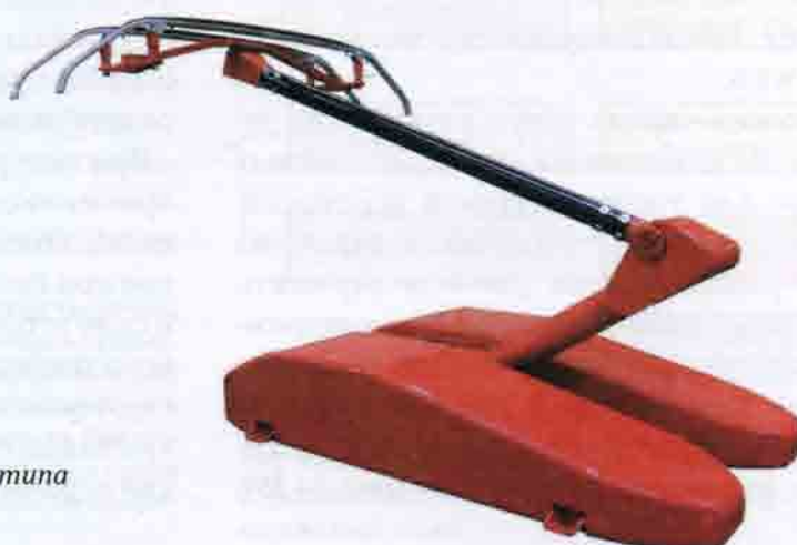
Рис. 14.37. Одноштанговые токоприемники PS9037, PS9038 японских высокоскоростных поездов последних разработок: а — общий вид; б — токоприемник PS9037, установленный на крыше вагона поезда серии E5
