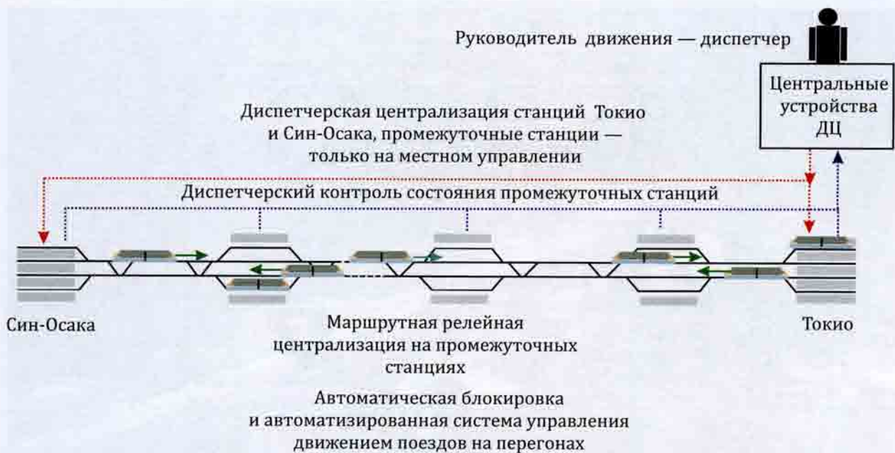
Рис. 18.6. Упрощенная схема системы управления движением поездов на ВСМ Токио — Осака в первые годы эксплуатации (1964—1972)
