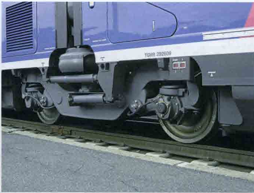
Рис. 12.9. Сочлененные вагоны поезда TGV, опирающиеся на промежуточную тележку. Франция. 2010 г.
