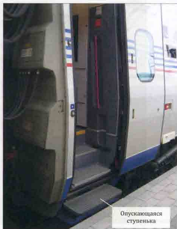
Рис. 12.28. Вагон высокоскоростного поезда «Аллегро»: а — с выдвинутой ступенькой (площадкой) наружной двери у высокой платформы вокзала в Санкт-Петербурге; б — со спущенной выдвинутой нижней ступенькой у низкой платформы вокзала в Хельсинки. 2012 г.
