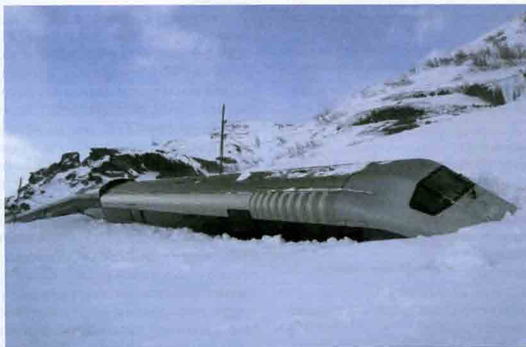
Рис. 17.12 (начало). Снежные заносы на ВСМ: а — высокоскоростной поезд серии BM71, сброшенный с рельсов сошедшей снежной лавиной (Норвегия)
