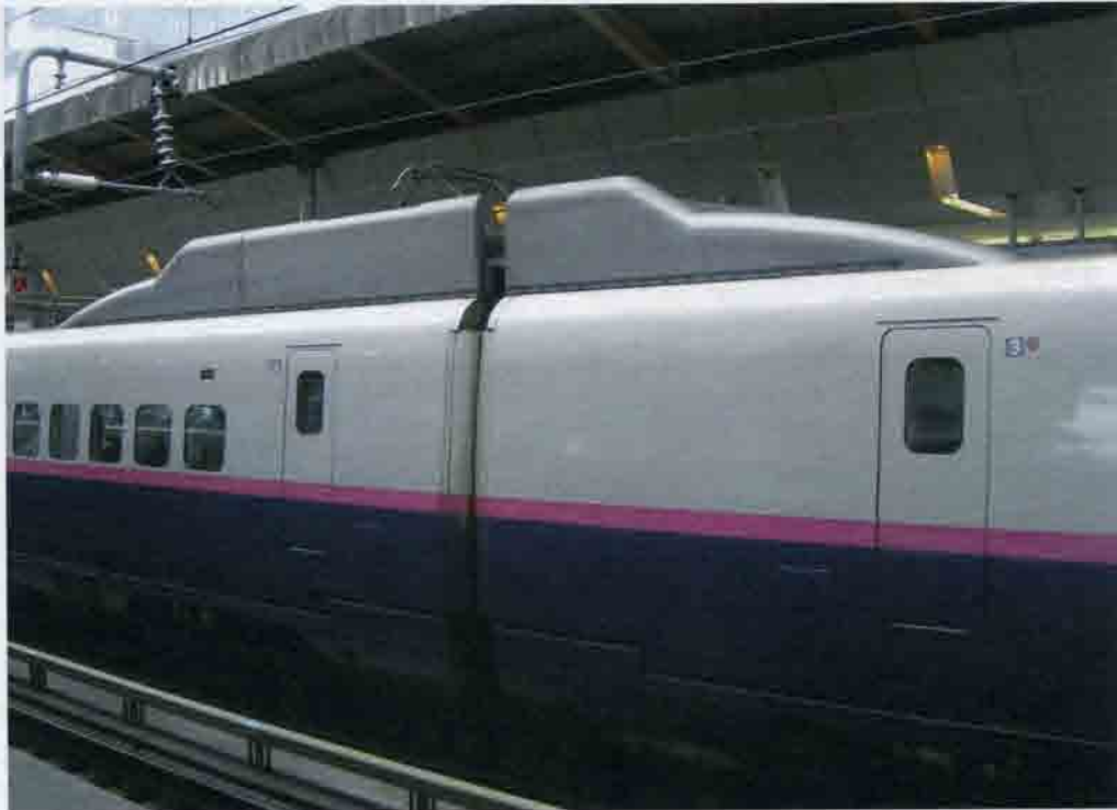
Рис. 14.40. Аэродинамические противозумовые экраны, прикрывающие токоприемники поезда серии E2. Япония
