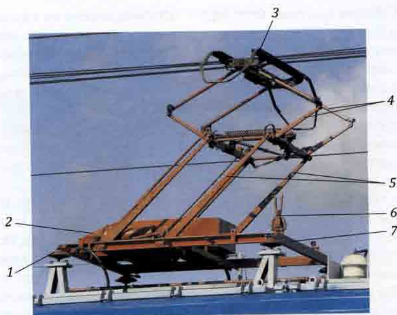
Рис. 14.34. Токоприемник электропоезда ЭР200 и электровоза ЧС200 (одна из последних модификаций): 1 — изолятор; 2 — кожух механизма подъема; 3 — полз; 4 — подвижные рамы верхней системы; 5 — подвижные рамы нижней системы; 6 — блокировка; 7 — основание
