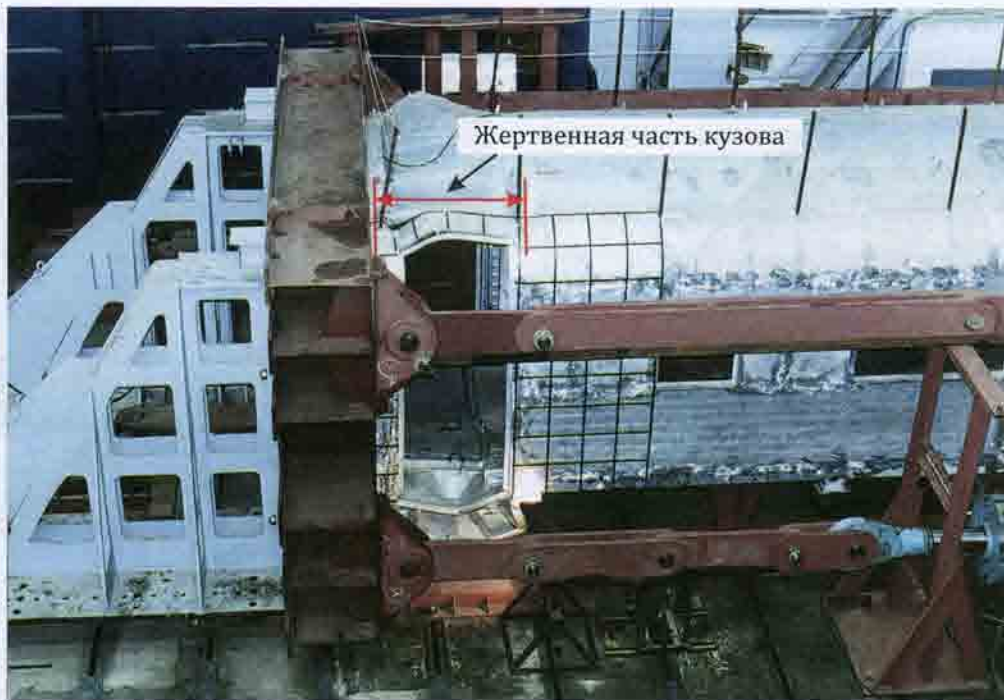
Рис. 13.13. Деформация жертвенной части кузова при испытании на продольное сжатие; смятие и выпучивание элементов конструкции крыши и рамы в районе тамбура вагона электропоезда «Сокол». Россия, 1999 г.
