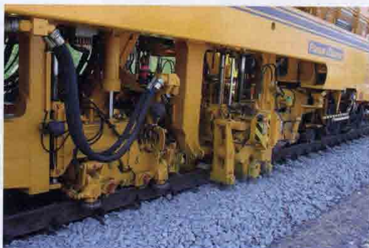
Рис. 20.22. Выправочно-подбивочно-рихтовочная машина Duomatic 09-32 CSM: а — общий вид; б и в — рабочие органы. Австрия
