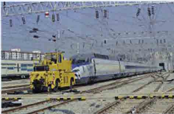
Рис. 21.11. Транспортные средства депо: а — радиуправляемая аккумуляторная электротележка с подъемной платформой для подачи деталей, материалов и оборудования; б — передвижная платформа-подъемник для транспортировки крупногабаритных грузов; в — тягач на совмещенном автомобильно-железнодорожном ходу для перестановки ремонтируемых поездов и вагонов; г — платформа-транспортёр (трансбордер) для перевозки локомотивов и вагонов по территории депо
