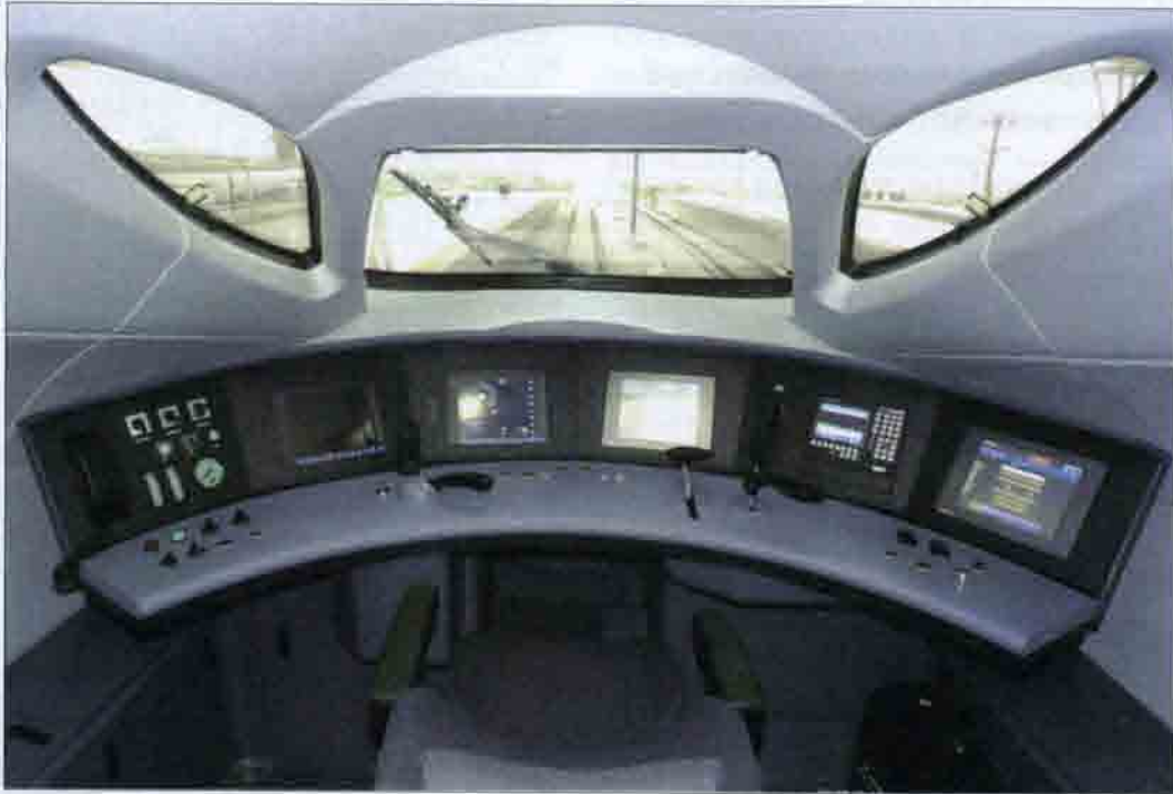
Рис. 15.15. Кабина машиниста и пульт управления поездом «Гармония» CRH380A. КНР. 2010
