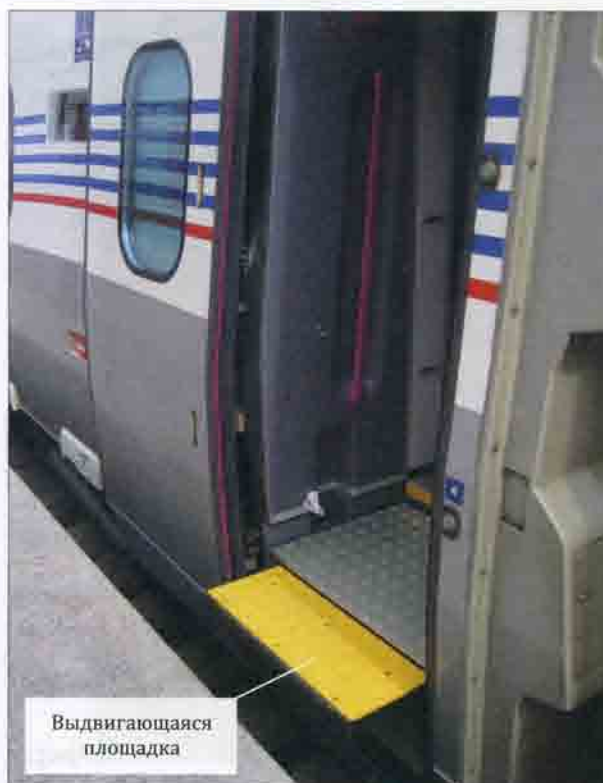
Рис. 12.28. Вагон высокоскоростного поезда «Аллегро»: а — с выдвинутой ступенькой (площадкой) наружной двери у высокой платформы вокзала в Санкт-Петербурге; б — со спущенной выдвинутой нижней ступенькой у низкой платформы вокзала в Хельсинки. 2012 г.
