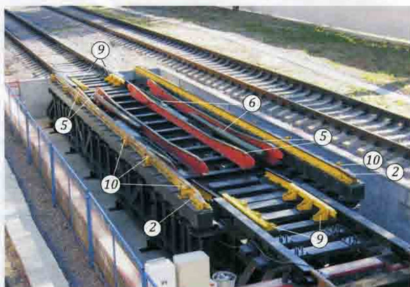
Рис. 13.88. Устройство для перехода подвижного состава типа Talgo с одной колеи на другую: а — схематическое изображение поперечного разреза тележки локомотива Talgo; б — схематическое изображение устройства для перехода с одной колеи на другую; в — схематическое изображение поперечного разреза тележки вагона Talgo Pendular; г — общий вид установки: 1 — рельсы широкой колеи; 2 — поднимающие балки; 3 — опоры скольжения рам тележек; 4 — замки-фиксаторы колес; 5 — Т-образные шины; 6 — направляющие балки; 7 — рельсы узкой колеи; 8 — увеличенное схематическое изображение, показывающее взаимодействие замка-фиксатора с Т-образной шиной; 9 — контр-рельсы входной/выходной частей переходного устройства; 10 — форсунки подачи воды для смазки
