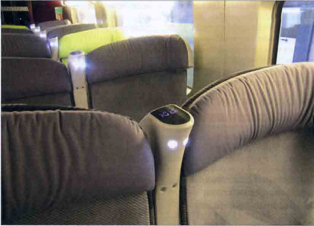
Рис. 12.33. Индивидуальные точечные светильники, размещенные в спинке кресла пассажира. Вагон высокоскоростного поезда TGV PSE (после реновации). Франция. 2005 г.
