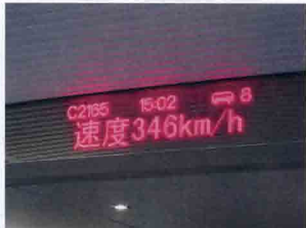
Рис. 12.34. Информационные указатели в пассажирских салонах: а — стрелочный указатель скорости в салонах вагонов первых поездов Синкансэн серии 0. 1964 г.; б — информационное табло в вагоне высокоскоростного поезда Velaro CRH 3 показывает: номер поезда, текущее время, номер вагона, скорость в данный момент. КНР 2010 г.
