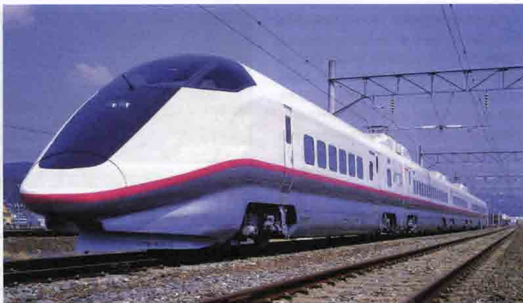
Рис. 13.61. Головной вагон высокоскоростного поезда серии ЕЗ в положении с закрытым обтекателем сцепного устройства. Япония. 2001 г.
