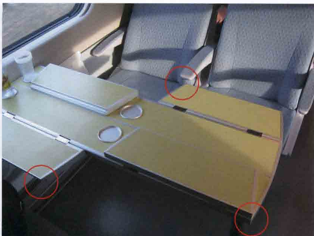
Рис. 12.25. Пример неудачного дизайнерского решения откидного столика — заостренные, отделанные металлом углы откидных элементов столешницы могут травмировать пассажиров
