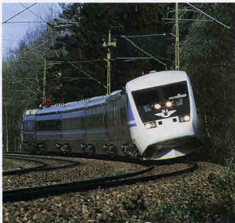
Рис. 13.80. Высокоскоростной поезд X2000 (X2): а — общий вид поезда со стороны концевой вагона с кабиной управления, проходящего кривую с наклоном кузовов вагонов; б — схема устройства наклона кузова вагона: 1 — колесная пара; 2 — рама тележки; 3 — пневматические рессоры центрального подвешивания; 4 — кузов вагона; 5 — качающаяся балка (опора пневматических рессор); 6 — гидроцилиндры наклона кузова; 7 — качающиеся подвески. Швеция. 1989 г.
