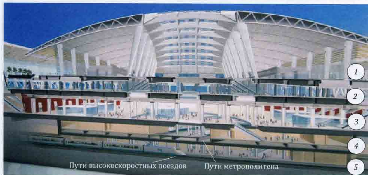
Рис. 19.14. На разрезе макета Южного вокзала показаны: 1 — верхний распределительный зал; 2 — залы ожидания, буфеты, кассовые и другие залы и помещения для обслуживания отъезжающих пассажиров; 3 — центральный распределительный зал и залы прибытия пассажиров; 4 — уровень станций городского метрополитена (в процессе строительства); 5 — уровень пассажирских платформ высокоскоростных поездов
