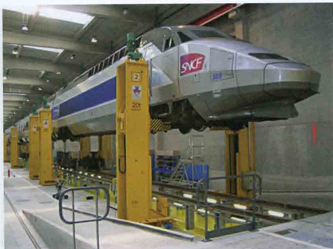
Рис. 21.4. Подъем в депо высокоскоростного поезда целиком без расцепки вагонов: Франция. 90-е годы XX столетия
