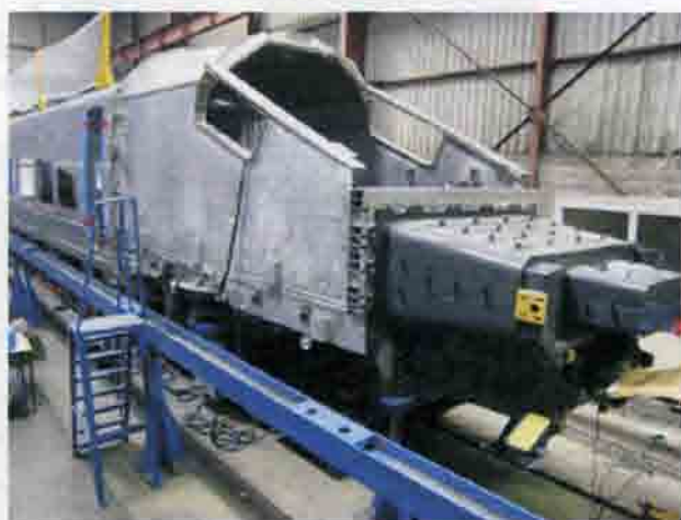
Рис. 13.14. Конструкция носовой части головного вагона высокоскоростного поезда AGV с энергопоглощающими модулями: а — схема размещения; б — общий вид на сборочном стапеле завода
