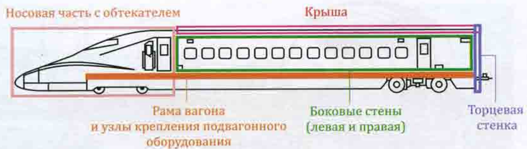
Рис. 13.28. Основные элементы кузова концевого вагона высокоскоростного поезда на примере поезда серии 700. Япония
