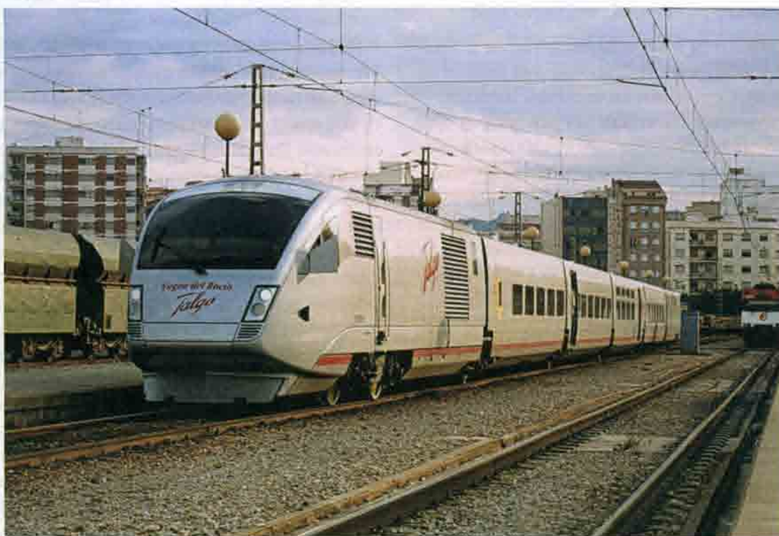
Рис. 13.85. Дизель-поезд Talgo XXI включает два тепловоза мощностью по дизелю по 1500 кВт, расположенных по концам состава и работающих по системе «тяги-толкай». В поезд входят шесть вагонов на одноосных тележках типа Talgo с пассивными устройствами наклона кузова. 1999 г.
