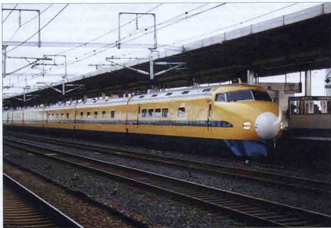
Рис. 20.1. Семивагонный инспекционный поезд серии 922-10, состав Т2
