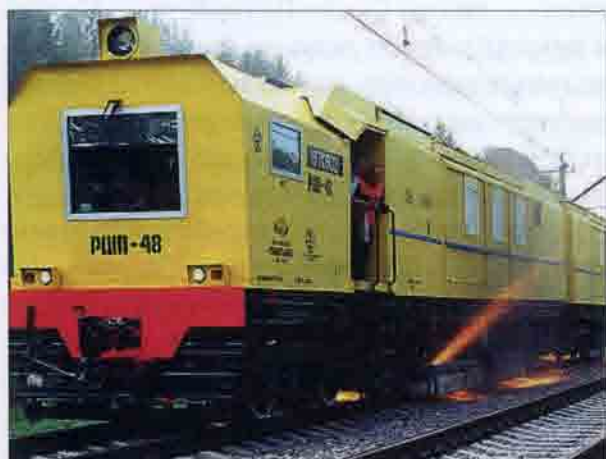
Рис. 20.25. Рельсошлифовальный поезд РШП-48: а — во время работы; б — шлифовальные головки. Россия («Ремпутьмаш»), Швейцария («Speno Sa»)
