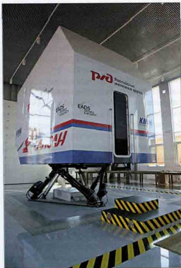
Рис. 17.36. Тренажер машиниста высокоскоростного поезда «Сапсан»: а — общий вид; б — основные элементы системы имитации движения на тренажере: 1 — опорная рама; 2 — бесщеточные сервомоторы; 3 — пневматические цилиндры; 4 — винтовые приводные механизмы; 5 — подвижная рама; 6 — блок управления
