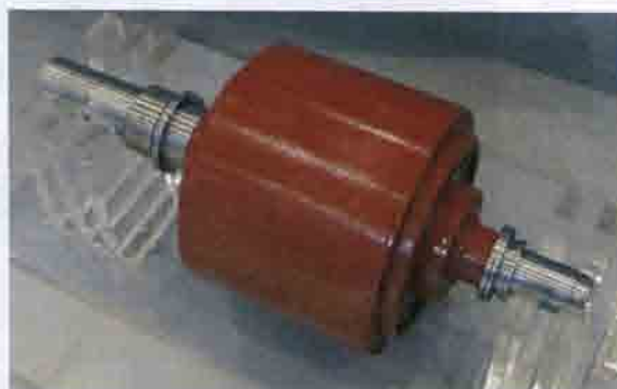
Рис. 14.14 (начало). Синхронные тяговые двигатели высокоскоростного подвижного состава: а — концерна Hyundai Rotem (мощность 410 кВт, напряжение 2150 В, максимальная частота вращения 4530 об/мин, масса в сборе 530 кг), общий вид (слева) и ротор
