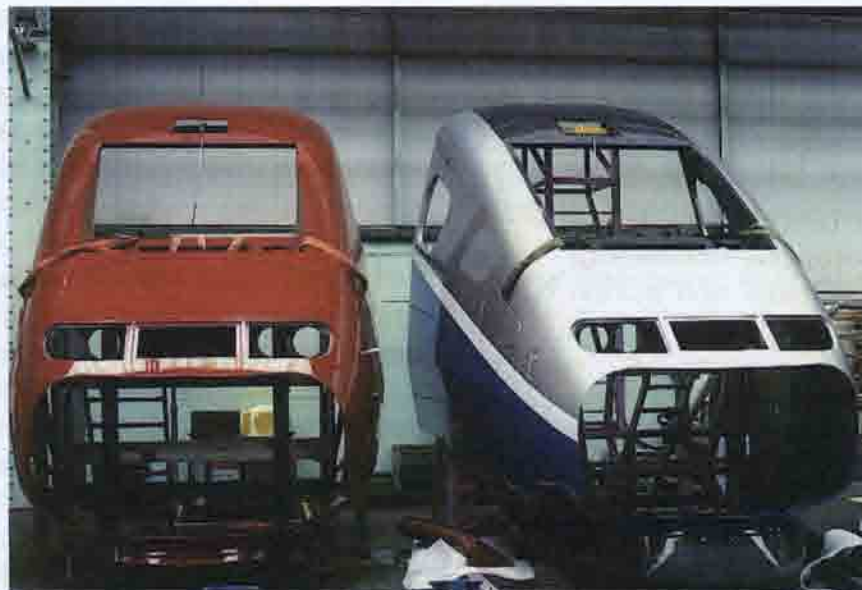
Рис. 13.34. Обтекатели носовых частей электропоездов высокоскоростных поездов Thalys PBKA (слева) и TGV Duplex, изготовленные из стеклопластика. Завод компании Alstom. Франция. 1996 г.
