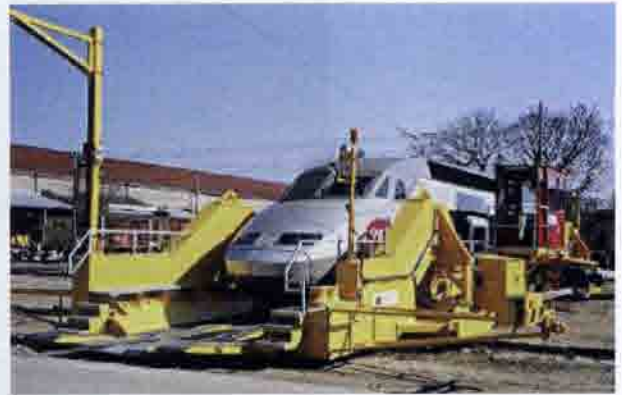
Рис. 21.11. Транспортные средства депо: а — радиуправляемая аккумуляторная электротележка с подъемной платформой для подачи деталей, материалов и оборудования; б — передвижная платформа-подъемник для транспортировки крупногабаритных грузов; в — тягач на совмещенном автомобильно-железнодорожном ходу для перестановки ремонтируемых поездов и вагонов; г — платформа-транспортёр (трансбордер) для перевозки локомотивов и вагонов по территории депо
