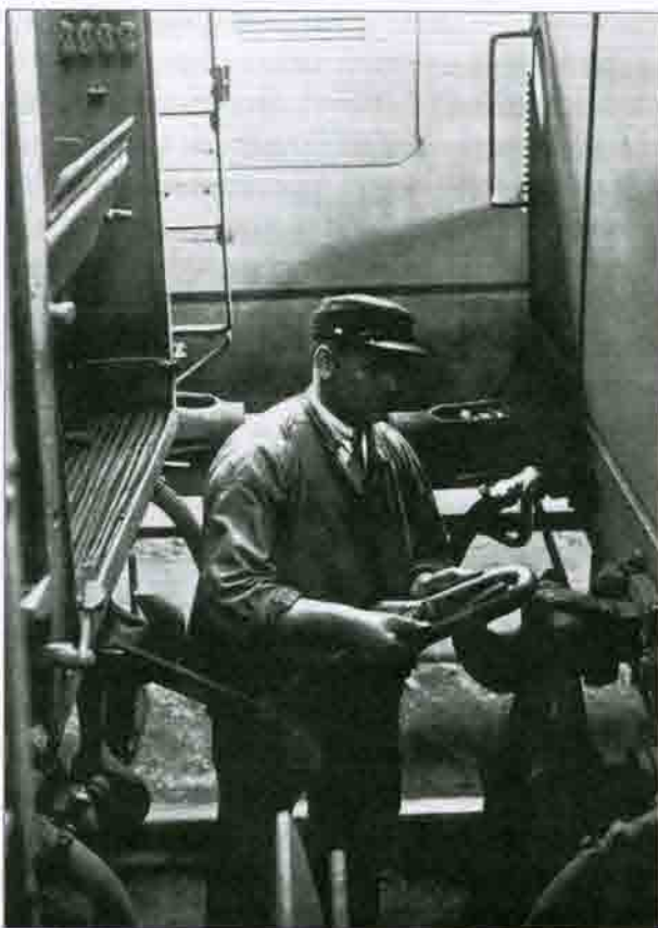
Рис. 13.58. Сцепные приборы с винтовой стяжкой: а — общий вид; б — сцепщик вагонов за работой
