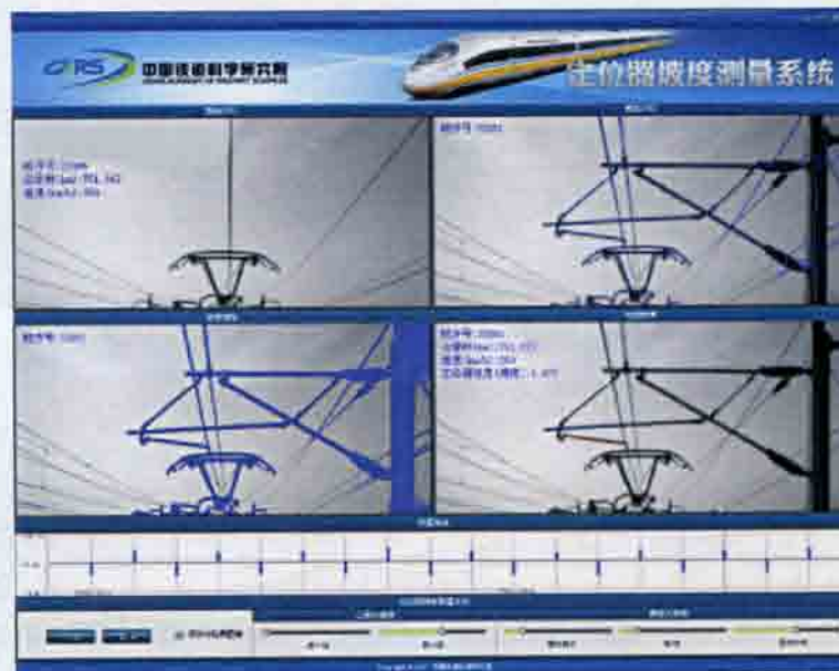
Рис. 20.16. Изображение на экране монитора состояния контактной сети в процессе инспекционной поездки
