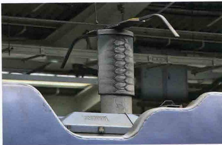
Рис. 14.36. Токоприемник телескопического типа высокоскоростного поезда серии 500. Япония. 1997 г.
