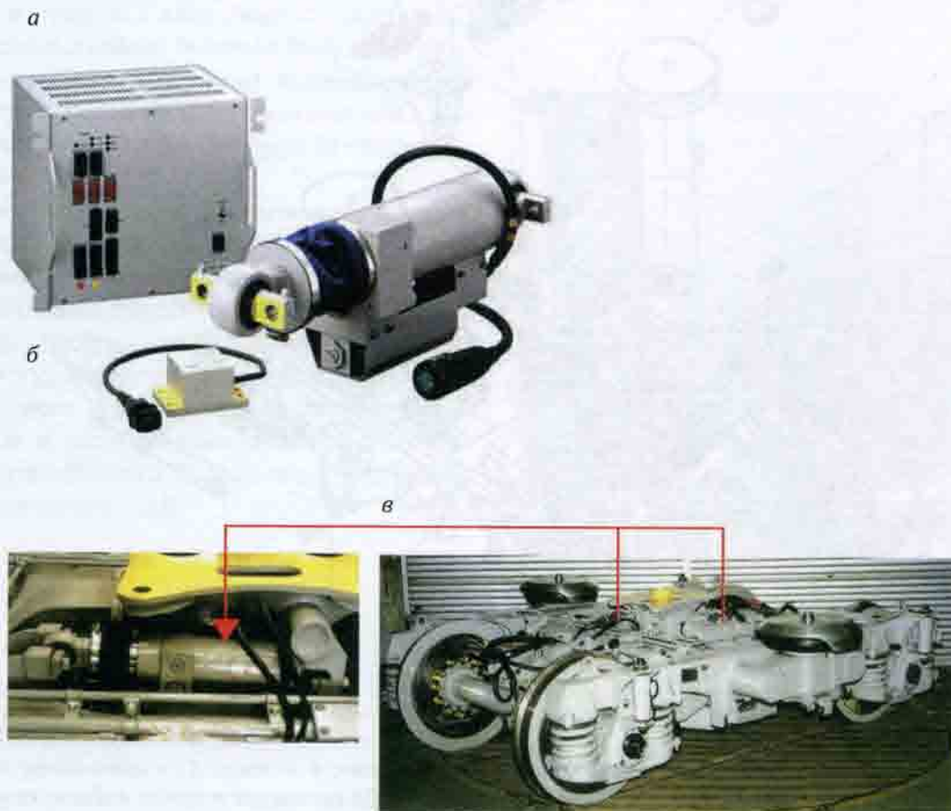
Рис. 13.55. Система подавления колебаний вагона высокоскоростного японского поезда серии N700: а — контроллер управления; б — гидравлический гаситель колебаний переменного сопротивления с блоком коммутации; в — размещение на тележке
