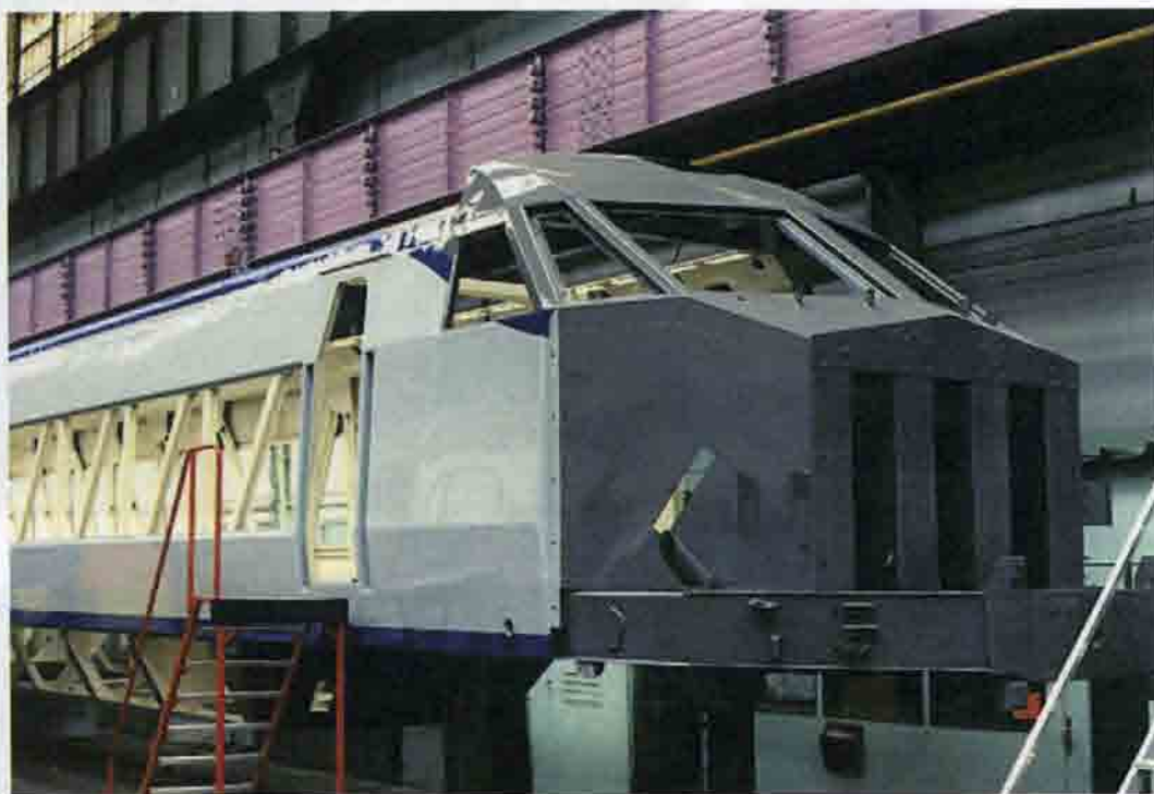
Рис. 13.33. Кузов электровоза высокоскоростного поезда КТХ. Завод компании Alstom, Франция, 1996 г.
