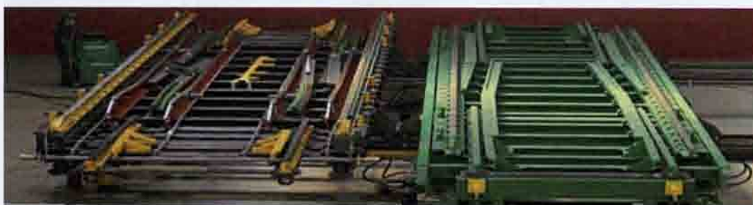
Рис. 13.90. Общий вид устройств для перехода с одной колеи на другую компании Talgo (слева) и компании CAF. Испания
