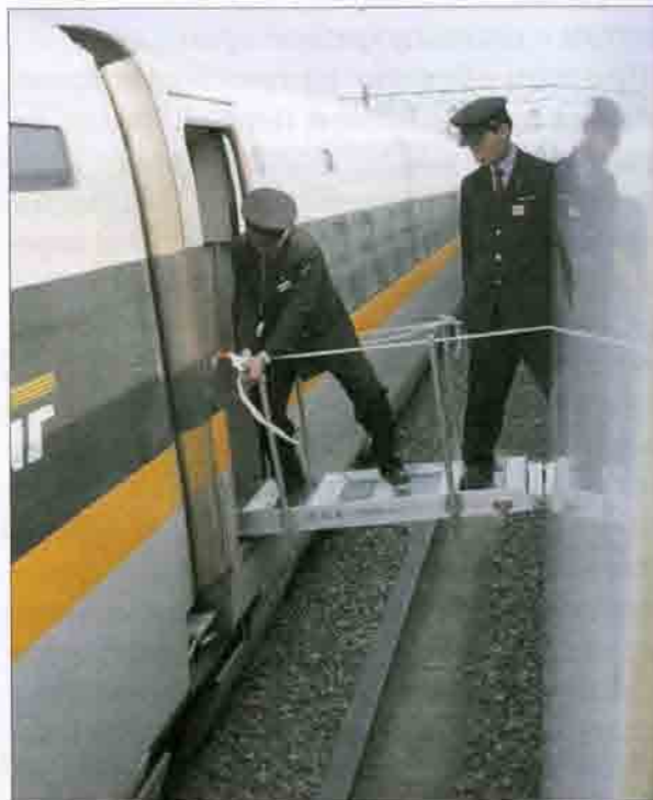
Рис. 17.37. Учения по ликвидации чрезвычайного происшествия на линии Синкансэн: а — эвакуация пассажиров из аварийного поезда; б — пересадка пассажиров из аварийного в спасательный поезд с помощью переходных мостков
