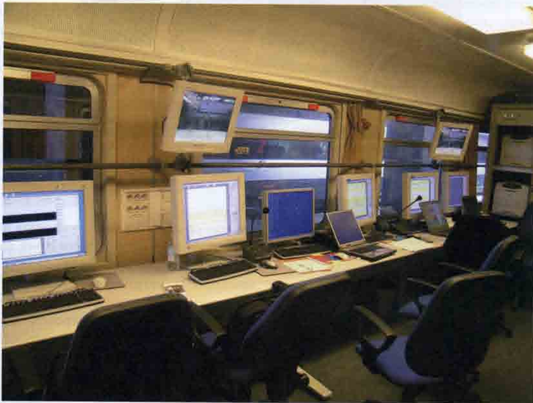
Рис. 20.14. Измерительный вагон инспекционного поезда «Archimede»: а — рабочее место оператора-наблюдателя за работой контактной сети; б — интерьер рабочего помещения операторов. Италия, 2005 г.
