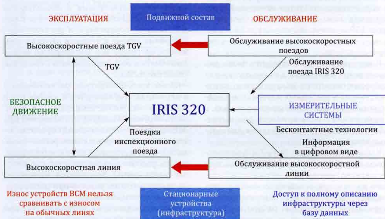
Рис. 20.12 (начало). Структурные схемы информационного обеспечения работы инспекционного поезда IRIS-320: а — алгоритм обработки информации в реальном масштабе времени; б — структурная схема включения поезда в систему эксплуатации и обслуживания железнодорожных линий и поездов TGV во Франции
