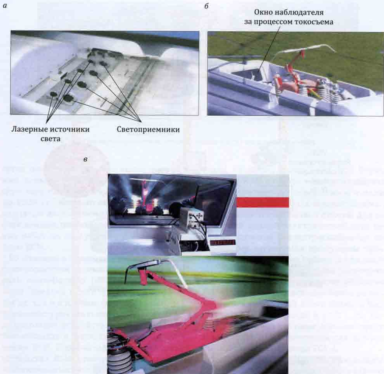
Рис. 20.8. Контроль состояния контактной подвески и процесса токоосъема: а, б — устройства лазерного сканирования положения контактного провода; в — пост наблюдателя за работой токоприемника и контактной сети (врезка) и общий вид токоприемника
