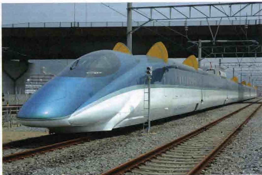
Рис. 15.8. Опытный поезд Fastech 360 с выдвинутыми в рабочее положение крыльями спойлерных аэродинамических тормозов (Япония). 2005 г.
