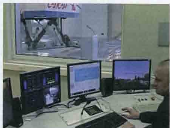
Рис. 17.38. Тренажер скоростного поезда «Сапсан»: а — рабочее место обучаемого; б — рабочее место инструктора
