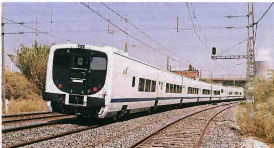
Рис. 13.84. Скоростной поезд из прицепных вагонов типа Talgo (на переднем плане фото — концевой вагон поезда, движущегося от наблюдателя). 2000 г.
