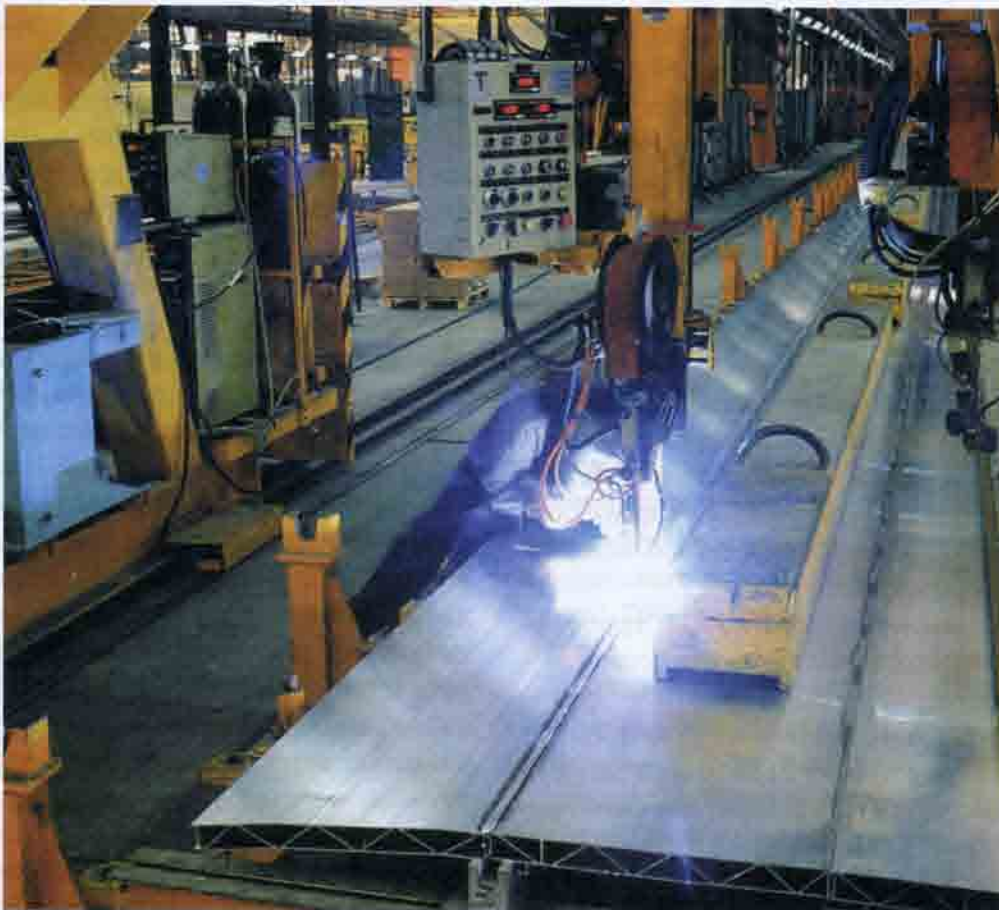
Рис. 13.16. Изготовление кузова вагона поезда Pendolino с применением автоматической электродуговой сварки
