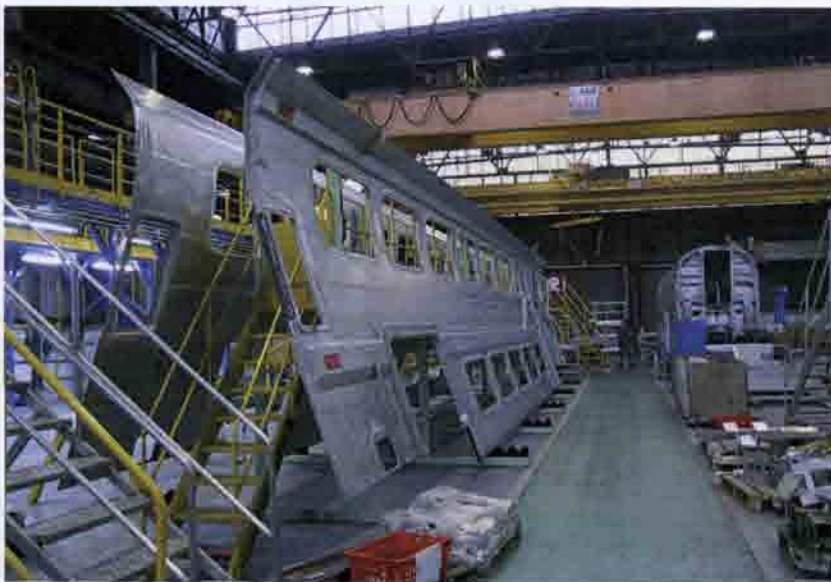
Рис. 13.23. Двухэтажные вагоны поезда TGV2N, изготовленные с использованием длинномерных панелей из легких сплавов: а — стенки кузова вагона в сборочном цехе завода компании Alstom. Франция. 2006; б — схематическое изображение элементов
