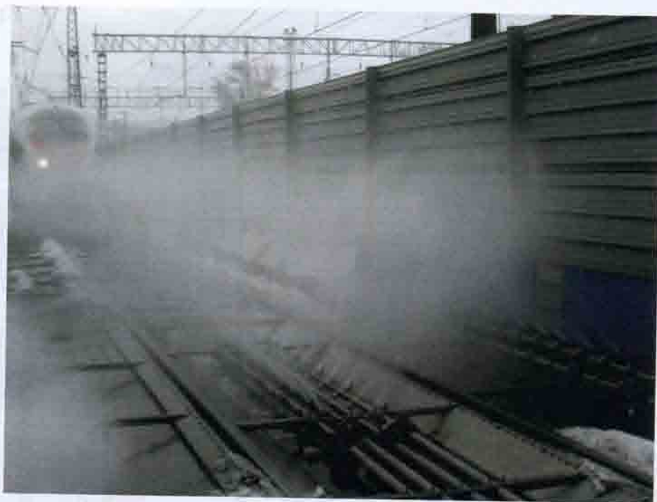
Рис. 21.20. Установка «АНТИЛ» обеспечивает ускорение удаления снега и наледи путем обработки разогретым раствором пропиленгликоля
