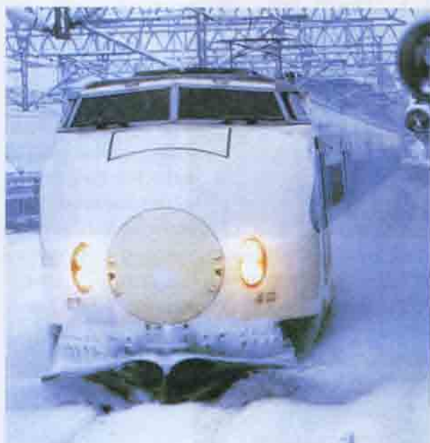
Рис. 17.13. Поезд серии 200 со снегоочистителем на головном вагоне. Япония
