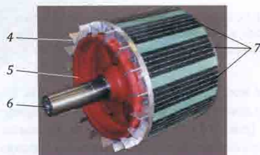
Рис. 14.14 (окончание): б — компании «Тошиба», общий вид (слева) и ротор: 1 — вал двигателя; 2 — постоянные магниты в общем корпусе; в — поезда AGV — статор (слева) и ротор: 1 — магнитопровод; 2 — лобовые части 3-фазной обмотки статора; 3 — выводы обмотки статора, соединенной в звезду; 4 — лопатки вентилятора; 5 — втулка; 6 — вал тягового электродвигателя; 7 — постоянные магниты
