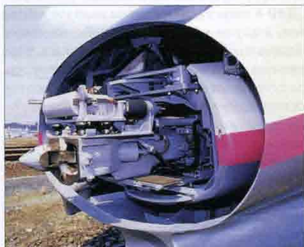
Рис. 13.62. Вид сцепного устройства поезда серии ЕЗ с открытым обтекателем. Япония 2001 г.
