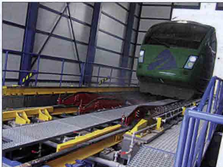
Рис. 13.89. Общий вид устройства для перехода с одной колеи на другую компании Talgo в момент пропуска по нему тепловоза
