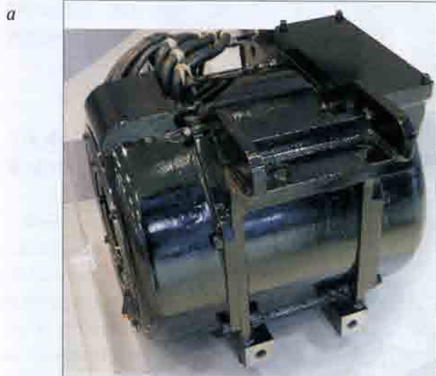
Рис. 14.14 (начало). Синхронные тяговые двигатели высокоскоростного подвижного состава: а — концерна Hyundai Rotem (мощность 410 кВт, напряжение 2150 В, максимальная частота вращения 4530 об/мин, масса в сборе 530 кг), общий вид (слева) и ротор
