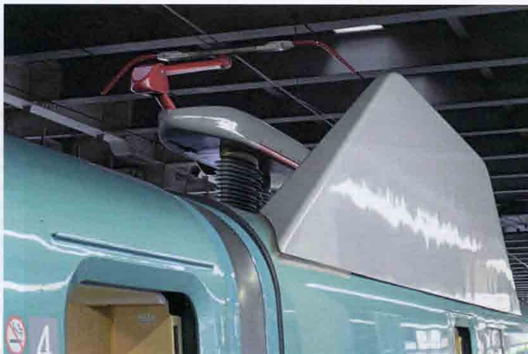
Рис. 14.37. Одноштанговые токоприемники PS9037, PS9038 японских высокоскоростных поездов последних разработок: а — общий вид; б — токоприемник PS9037, установленный на крыше вагона поезда серии E5
