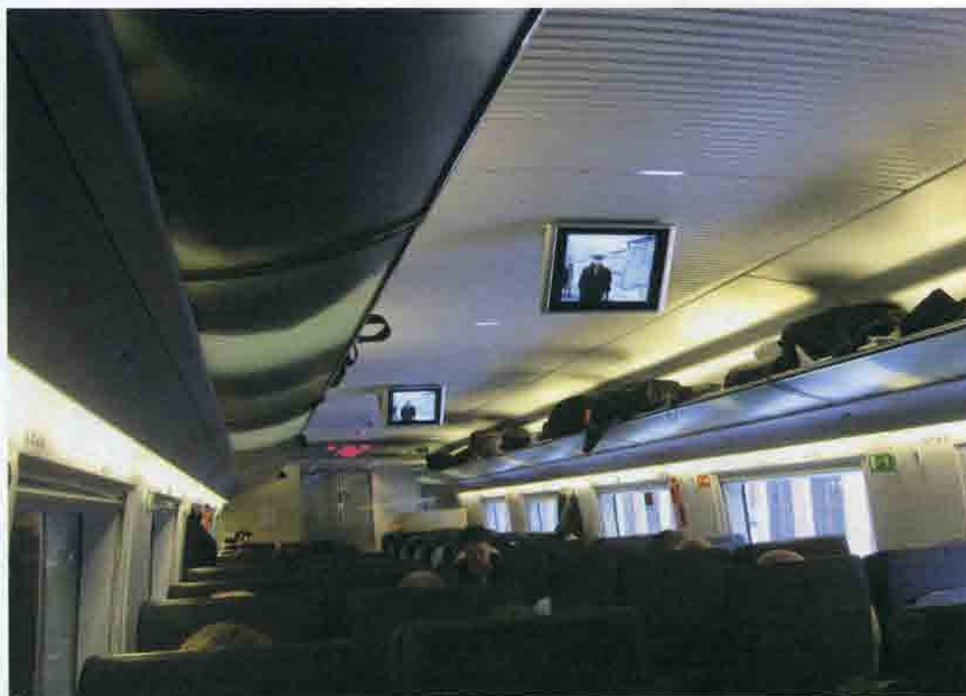
Рис. 12.32. Освещение салона вагона с помощью светильников, расположенных за потолочными карнизами и за багажными полками. Высокоскоростной поезд «Сапсан». Германия для России. 2009 г.
