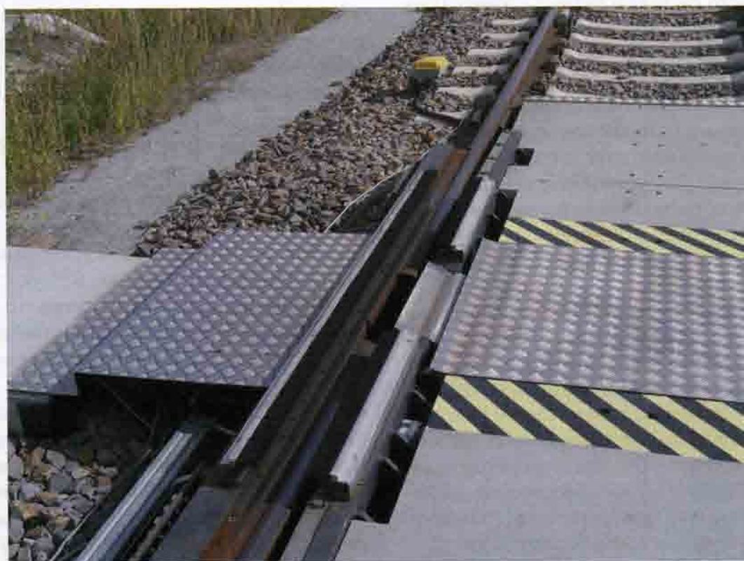
Рис. 21.1. Участок контроля состояния колесных пар депо высокоскоростных поездов Берлин-Руммельсбург: а — общий вид; б — блок датчиков контроля состояния и геометрических параметров колесных пар. Германия. 2012 г.
