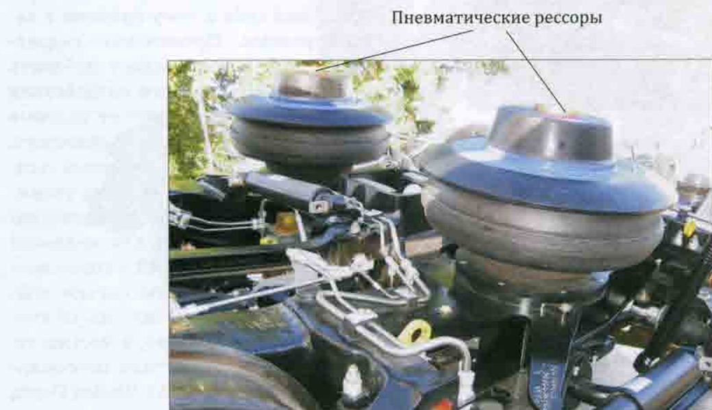
Рис. 13.49. Пневматическое подвешивание тележки вагона высокоскоростного поезда компании «Bombardier», 2008
