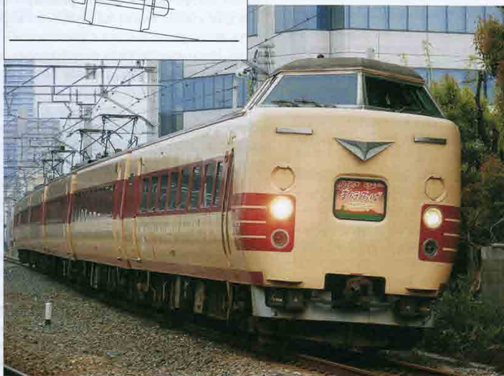
Рис. 13.65. Электропоезд серии 381; схема устройства наклона кузова: \text{Ц}_в — центр вращения; \text{Ц}_м — центр масс. Япония. 2010 г.
